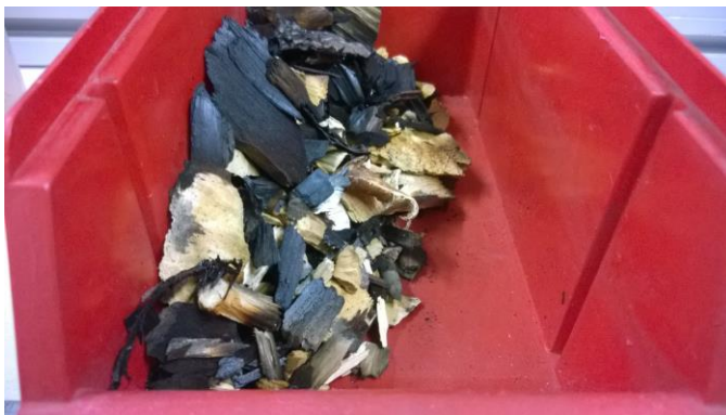
Kuva 16. Osittain hiiltynyttä haketta.
