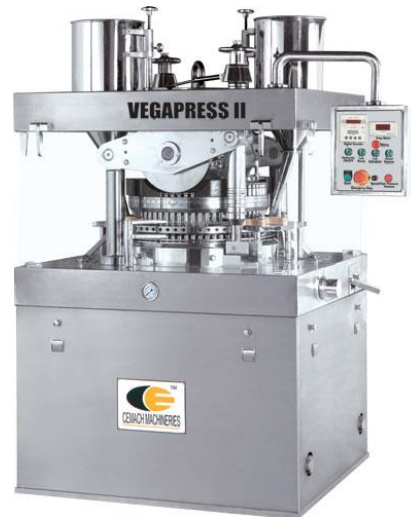
Kuva 14. Kaksipuolinen rotaatiopainimilla varustettu tablettipuristin tablettituotantoon (Vegapress II).
