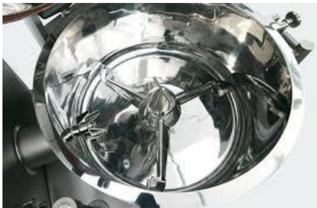
Kuva 6. High shear -sekoittaja sisältä kuvattuna (Roto Mix).
