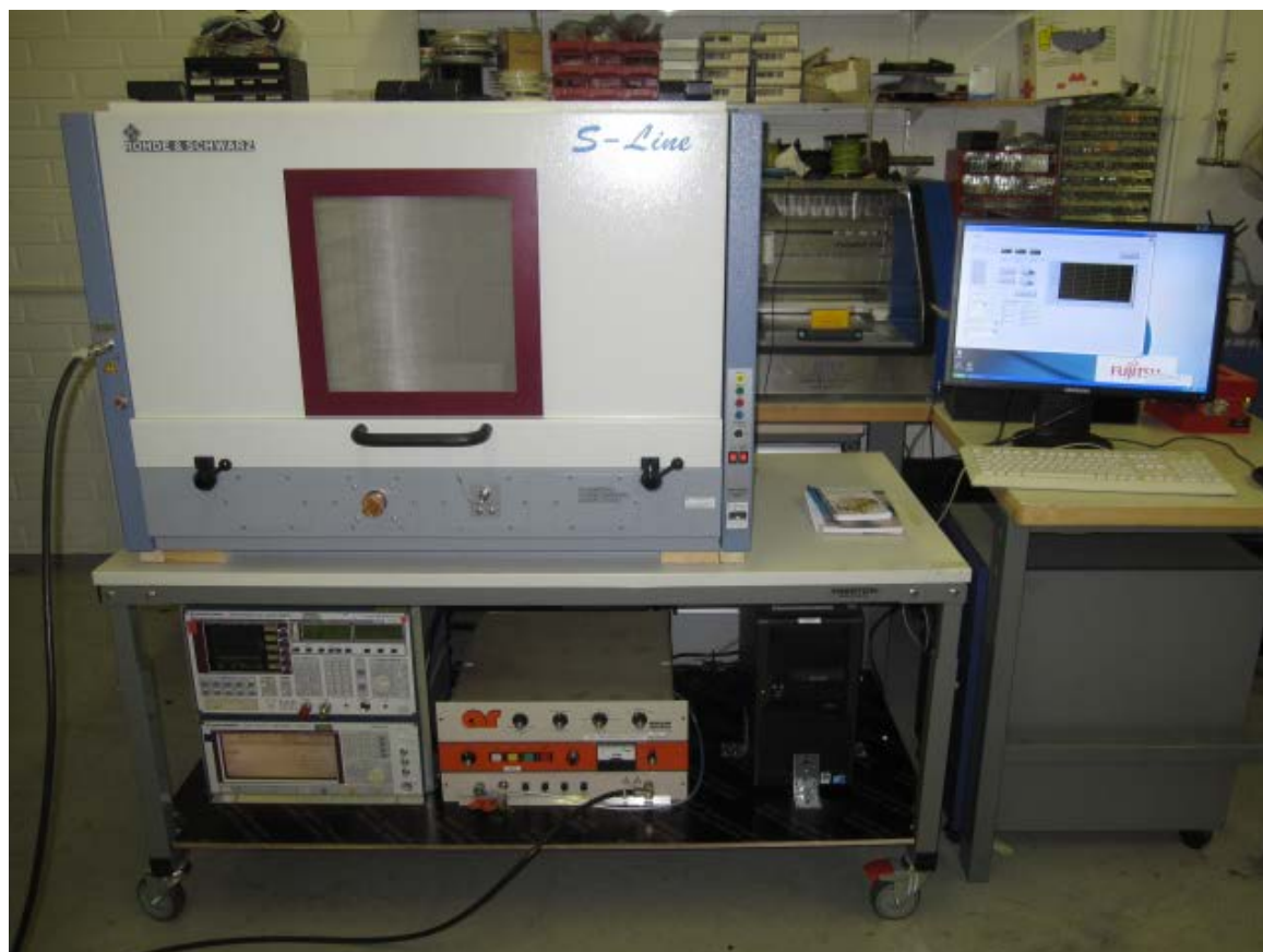
KUVA 8. Testauslaitteistosta, SLine 700 TEM -kammioista ja PC:stä koottu testausjärjestelmä.
