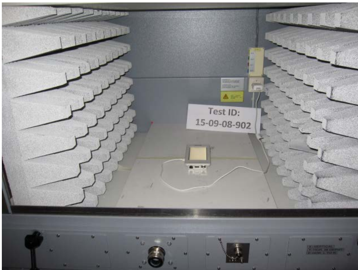
KUVA 15. Jhumar2:n emissiomittaukset SLinessä.
