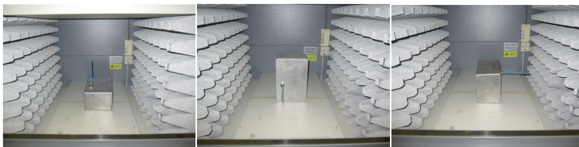
KUVA 1. Testattavan laitteen asemointi eri polarisaatiotasoja mitattaessa. Vasemmalla: vertikaali (X-suunta). Keskellä: horisontaali syvyys suunnassa (Y-suunta). Oikealla: horisontaali sivuttaissuunnassa (Z-suunta).
