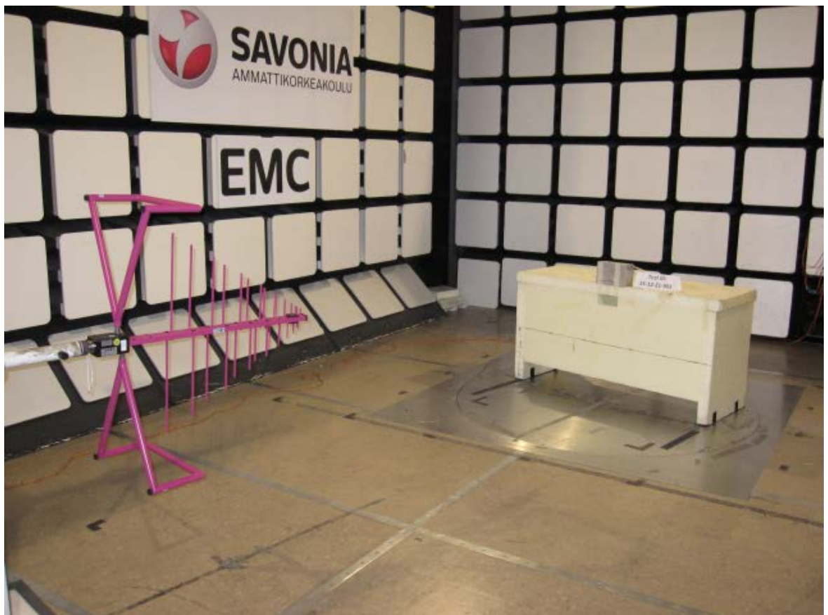
KUVA 1. Referenssisäteilijän mittaus Savonian EMC-laboratoriossa.
