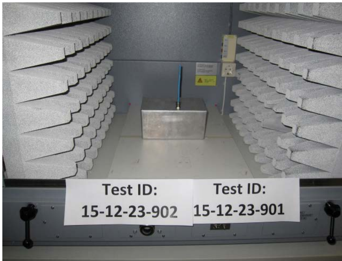
KUVA 2. Referenssisäteilijän mittaus SLinessä.
