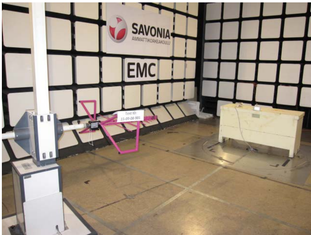
KUVA 14. Jhumar2:n emissiomittaukset Savonian EMC-laboratoriossa.
