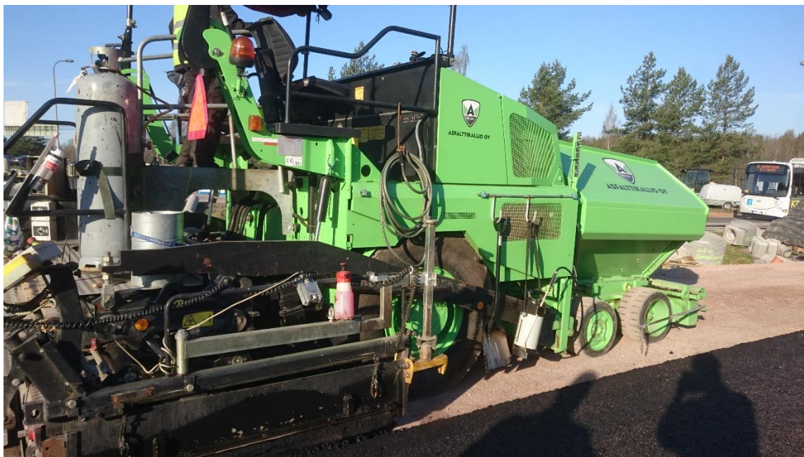
Kuva 8. Pyörävetoinen, kaasulla lämpiävä perä, Dynapacin levitin (Ukkola 2016-5-18)
