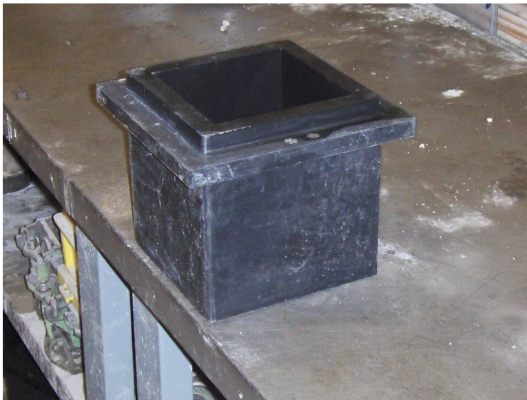
Kuva 3.2 Kuutiokoekappaleen muovinen valumuotti.
