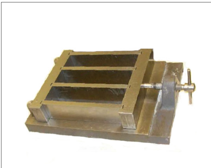
Kuva 3.4 Prismakoekappaleiden teräksinen valumuotti.
