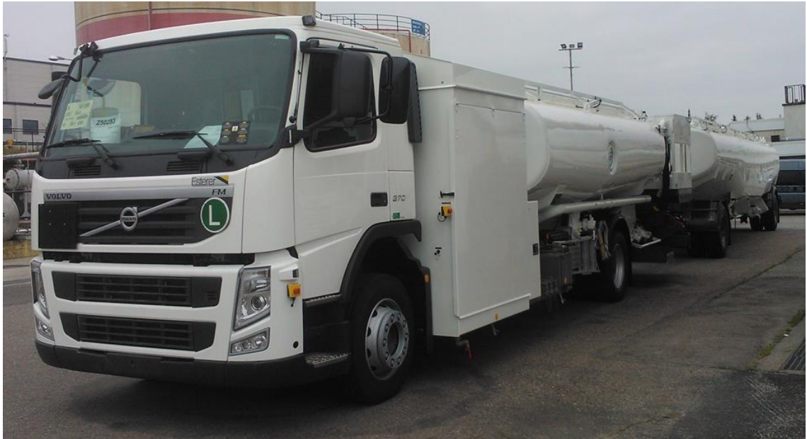
Kuva 2. Tyypillinen Helsinki-Vantaalla käytettävä tankkausajoneuvoyhdistelmä.
