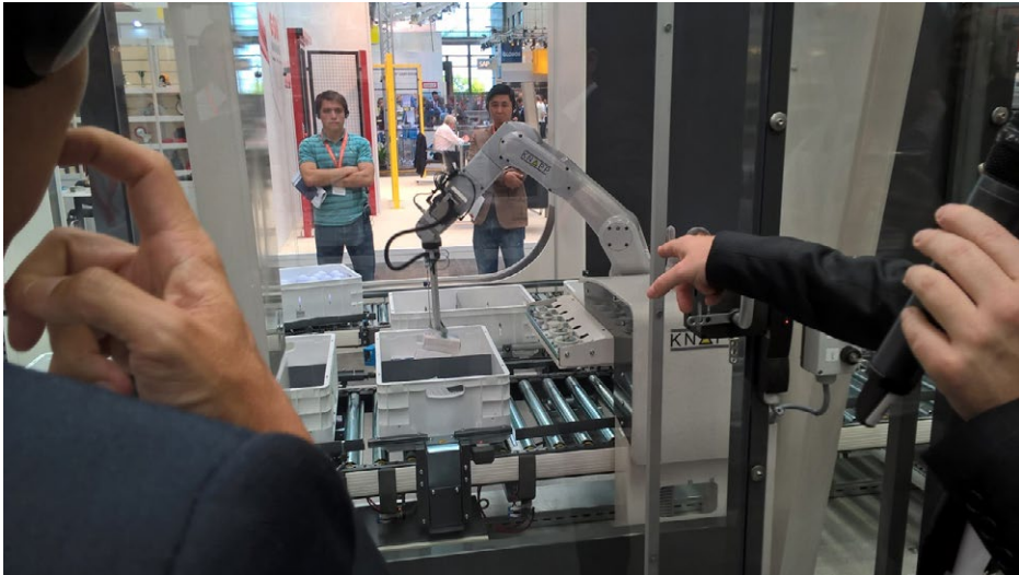
KUVA: Robotisoitu keräysasema (KNAPP, CeMAT-messut 2016)
