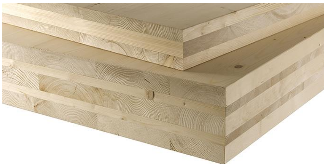
Kuvio 1. CLT-levyn rakenne (Stora Enso 2013)
