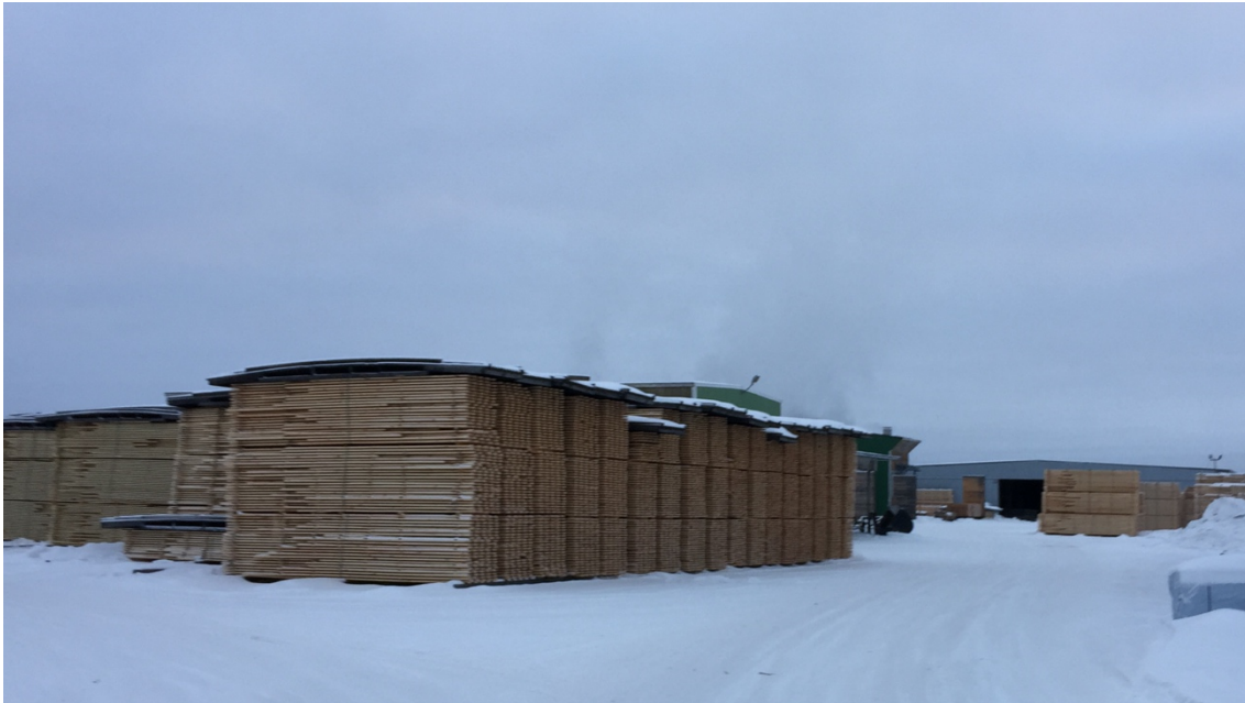
KUVA 13. Nippuja varastoituna siirrettävien kattojen alla
