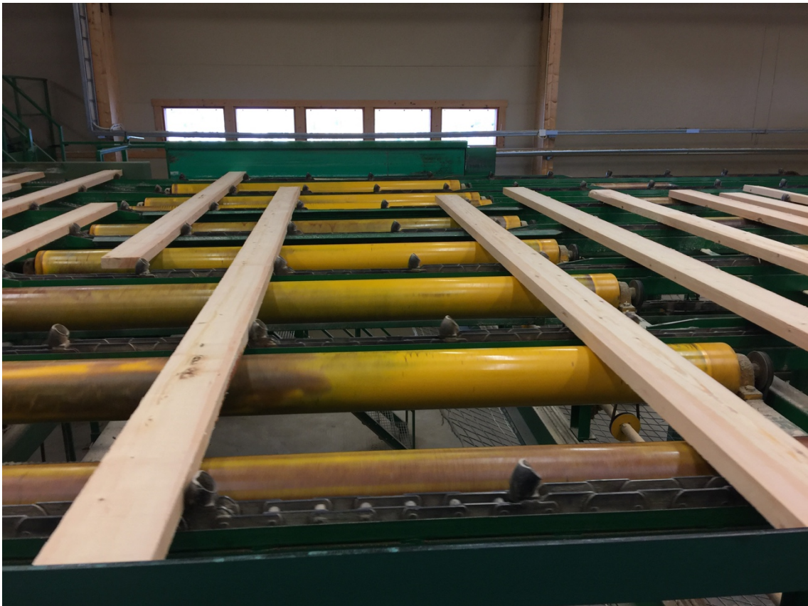
KUVA 11. Rimottamon kolakuljettimella oleva tyhjä kolaväli
