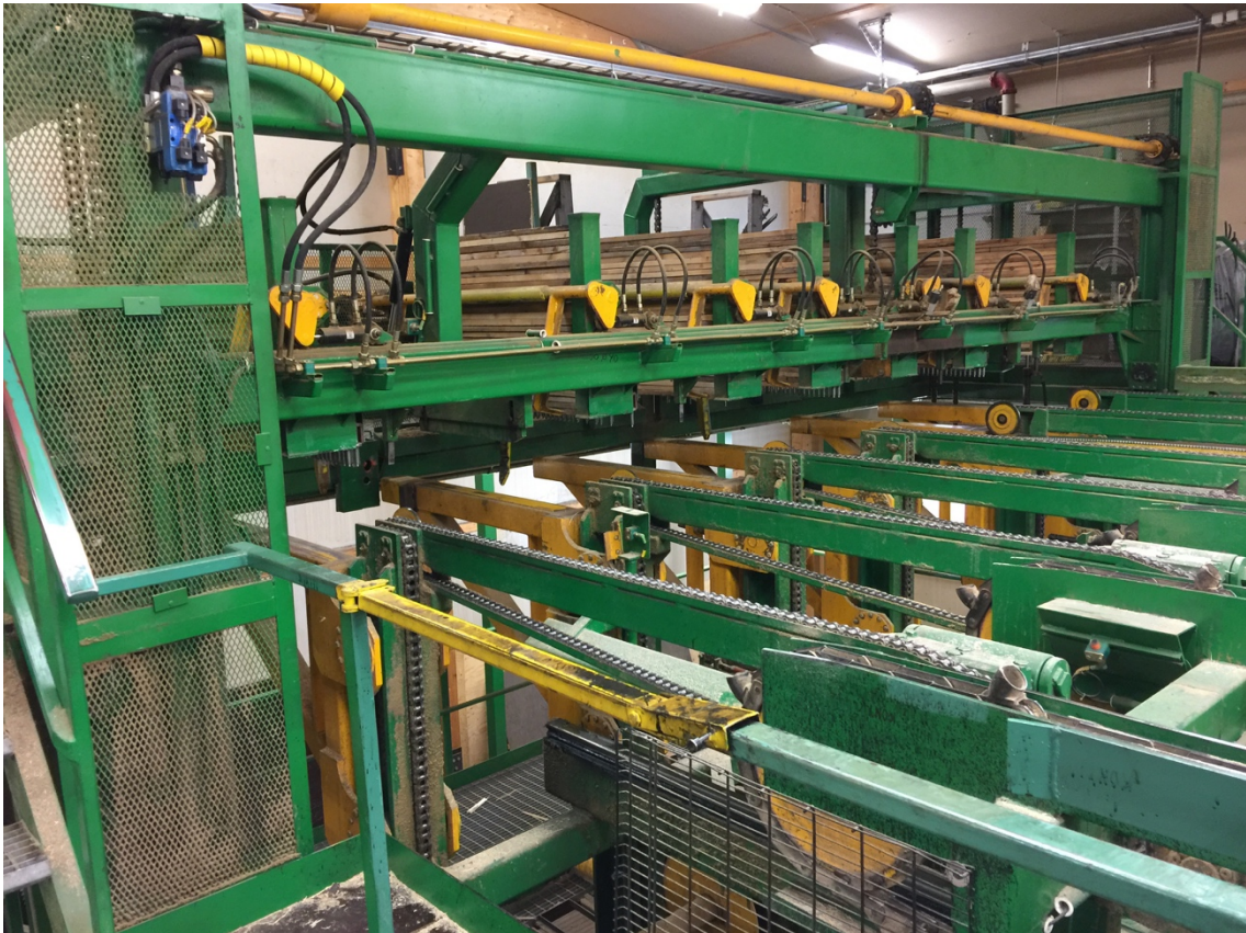
KUVA 6. Rimotuskone, rimotuskoneen seitsemän rimakasettia ja rimotuskoneen alla oleva pakettihissi, jolla lasketaan niput alas
