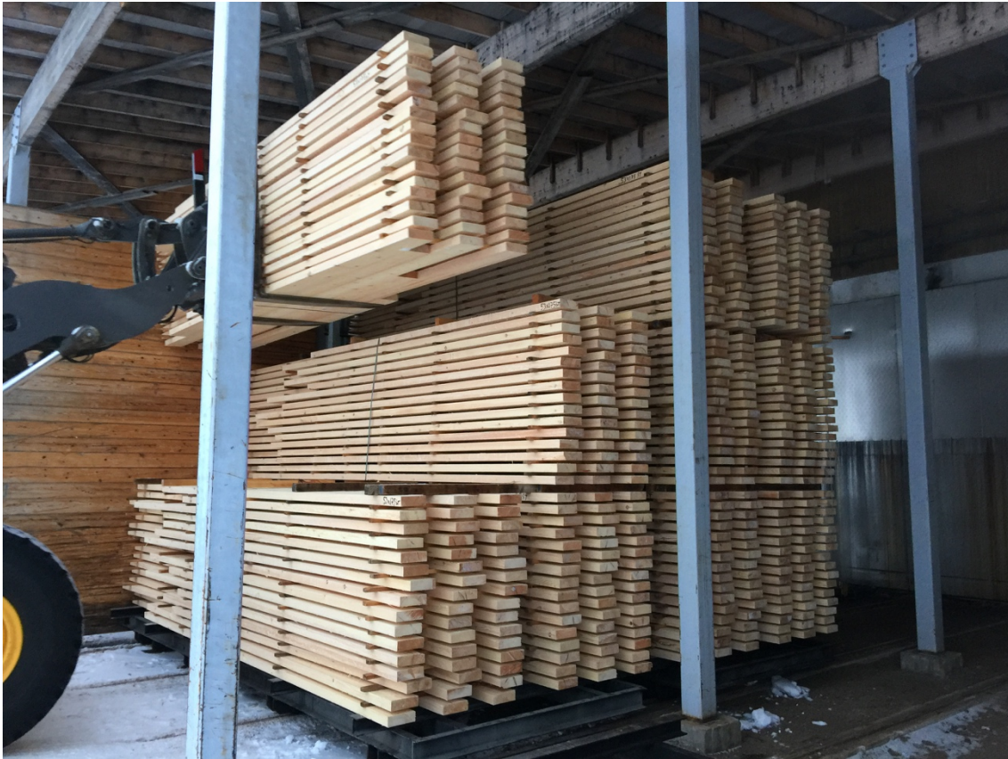
KUVA 12. Pyöräkone lastaamassa nippuja Uuden kuivaamon vaunuun
