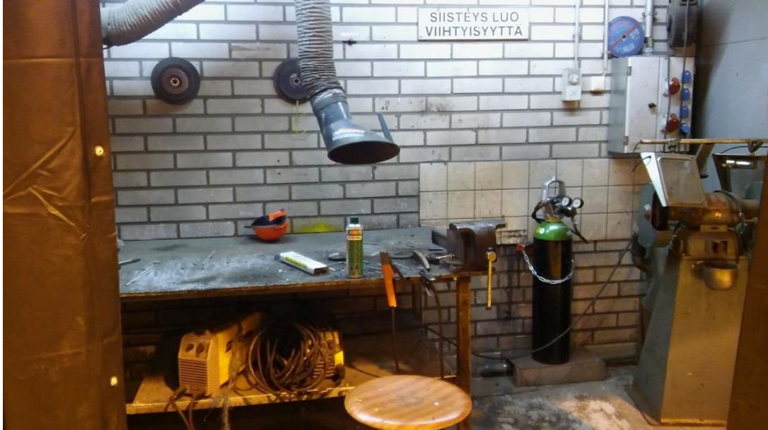
Kuva 14. Kiinteä hitsauspaikka, jossa on kohdepoisto.
