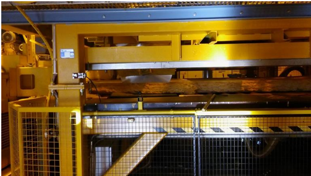
Kuva 17. Lasivillaa leikataan terällä.
