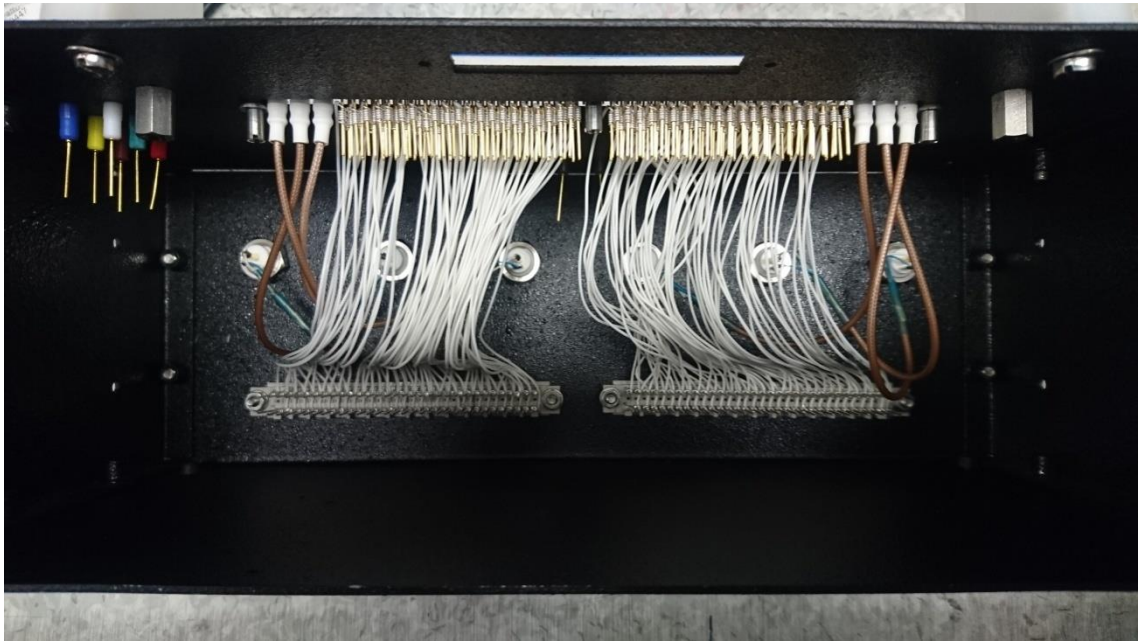
Kuva 5. Korttisoittimen korttiliittimen ja lattakaapeliliittimien välinen johdotus
