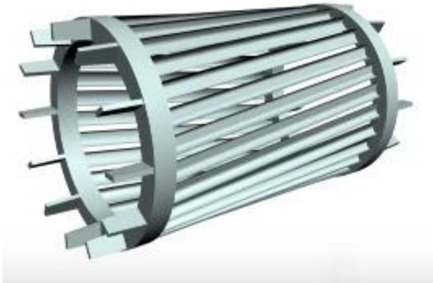
Kuva 4. Oikosulkuhäkki, jossa roottorisauvat ja oikosulkurenkaat (LearnEngineering)
