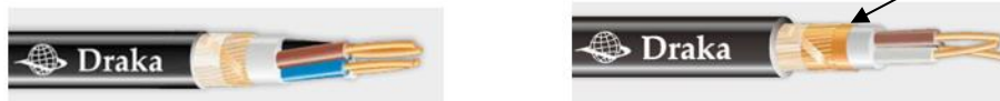
Kuva 33. Vasemmalla MCMK, jossa konsentrisen suojajohdin ja oikealla MCCMK, jossa lisäksi nuolen osoittama kuparifolio EMC-suojana (Draka)
