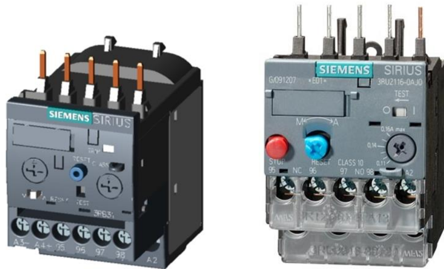
Kuva 24. Kuvassa vasemmalla on elektroninen lämpörele, jonka laukaisuluokka on valittavissa ja kuvassa oikealla on mekaaninen lämpörele, jonka laukaisuluokka on 10 (Siemens)
