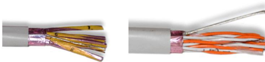
Kuva 34. Vasemmalla JAMAK, jossa jokainen johdinpari erikseen suojattu ja oikealla NOMAK, joka on parikierretty ja siinä vain vaipan alla folio (E. Parviainen)
