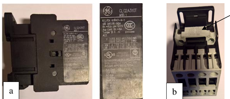
Kuva 18. Kontaktorin arvokilpi (a), josta nähtävissä sen käyttöluokka ja tehonkestoisuus. Kuvassa b, nuoli osoittaa kohdan, josta voi lukea kelajännitteen (E. Parviainen)
