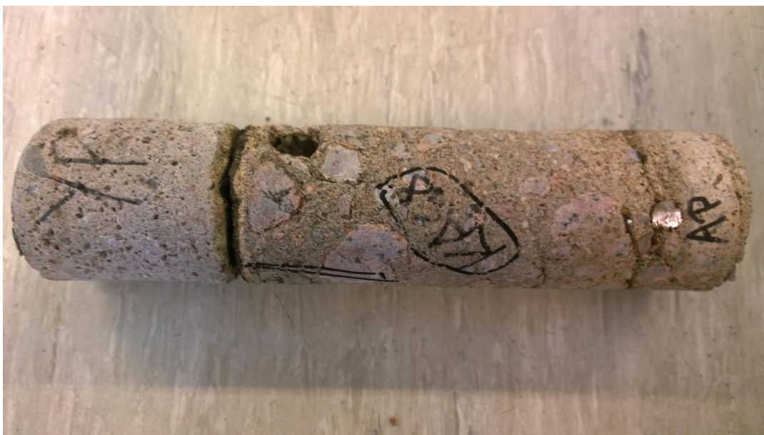
Kuva 12. Parvekelaatan poranäytteessä on havaittavissa pitkälle edennyttä pakkasrapautumaa [Kristian Koskenniemi]
