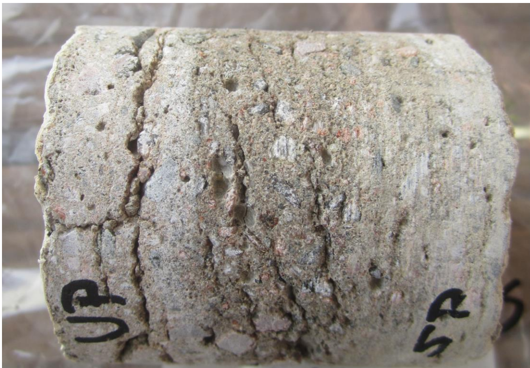
Kuva 14. Täysin rapautunut ja lujuuden menettänyt ulkokuoren poranäyte, näyte on otettu 1970-luvun maalipintaisesta julkisivuelementistä [Kristian Koskenniemi]
