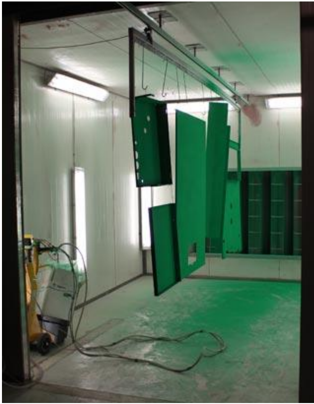
Kuvio 2. Kappaleita pulverimaalauksessa (Finlead Oy)
