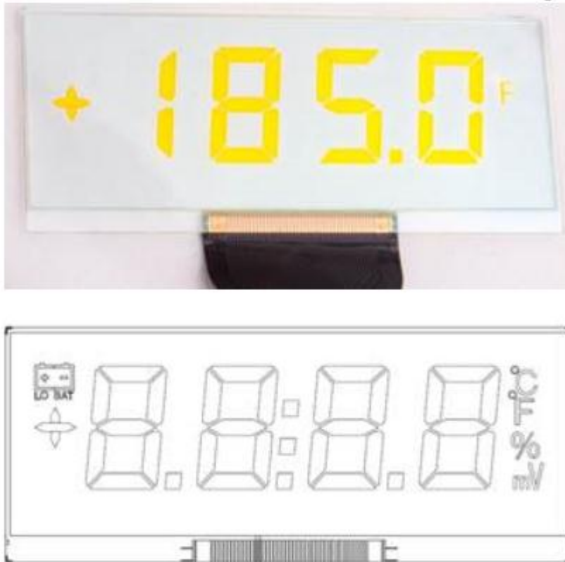
Kuva 4. Lumineqin segmenttinäyttö ja näytön litografia (Saikkonen 2017).
