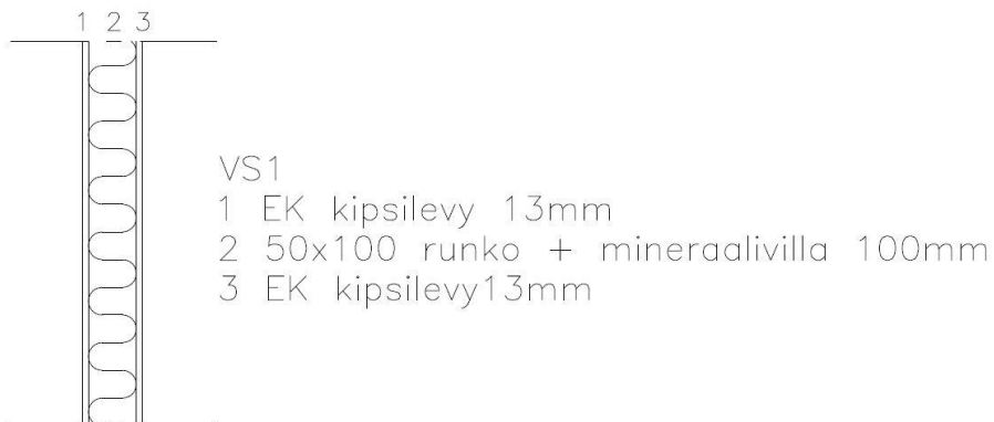
Kuva 8. Toimiston ja korjaamon välisen seinän rakenne (Valtonen 2016-09-28)
