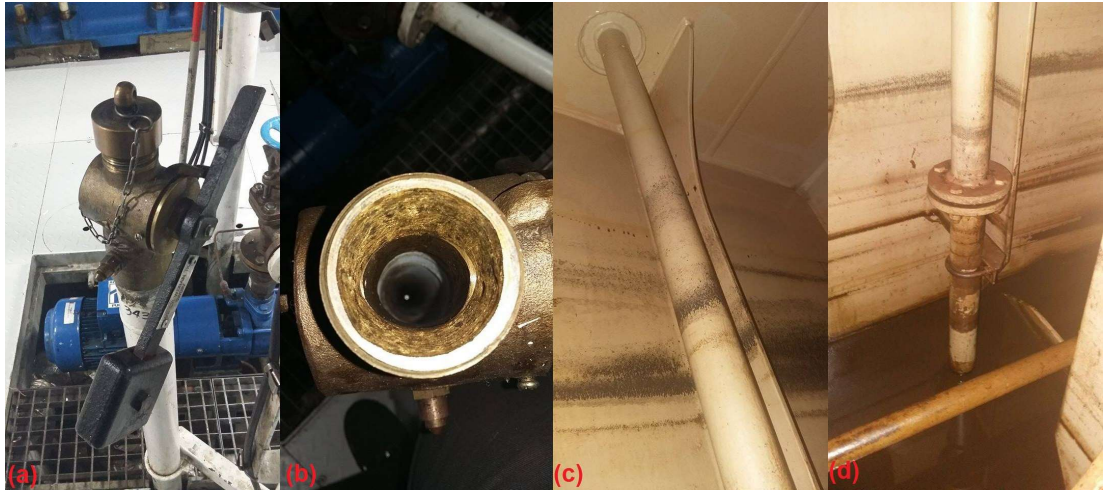
Kuva 8. Pohjaan ylettyvä peilausputki Finnwave -alukselta
