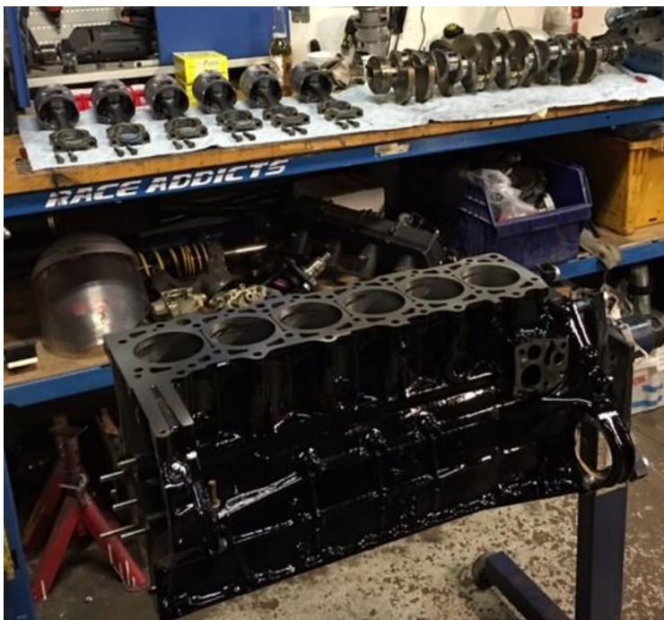
Kuva 17. Moottorinlohkon sylinterikannen tiivistepinta tasohiottuna.
