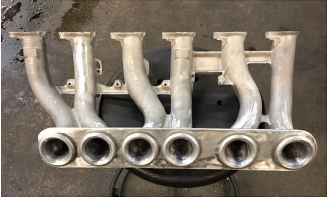
Kuva 11. Imusarja-aihiö, plenumin pohja sekä kiihdytyspilot hitsattuna.
