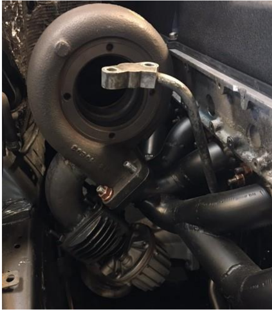
Kuva 16. Hukkaportti asennettuna poikkeuksellisesti suoraan turboahtimen pakopesään.
