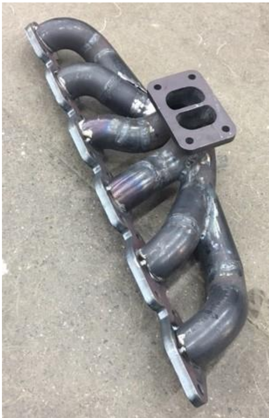
Kuva 10. Puolivalmis pakosarja osittain hitsattuna.
