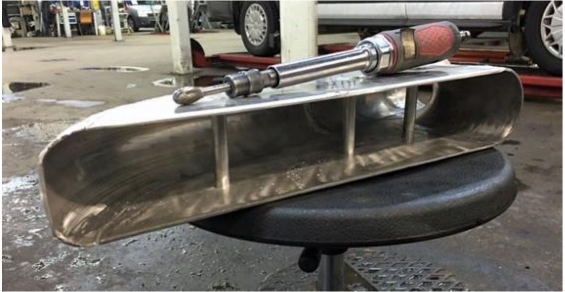
Kuva 12. Painekotelon sisäpinta siistittynä virtausvastusten minimoimiseksi.
