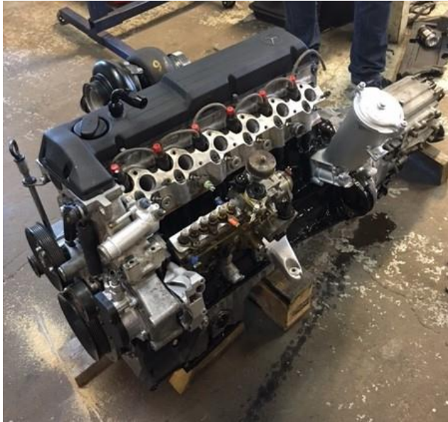
Kuva 18. Moottori koottuna ja syöttöpumppu ajoitettuna paikalleen.
