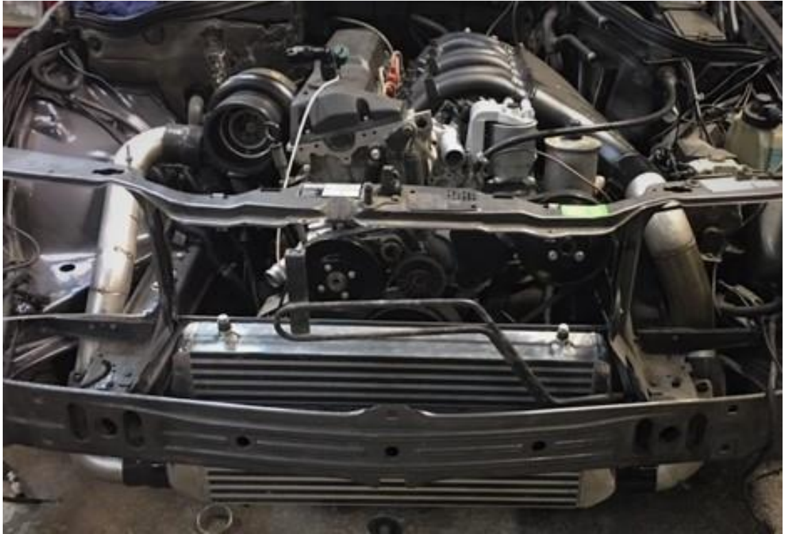
Kuva 14. Hitsausvalmiit paineputket koesovituksessa.
