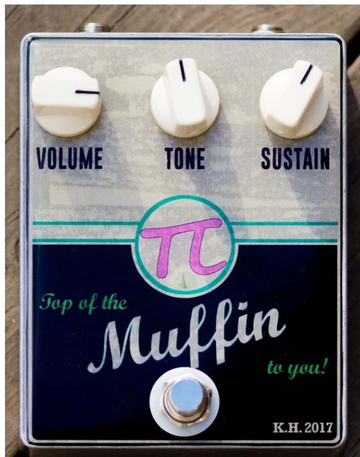
KUVA 31: Valmis efektilaite koteloituna
