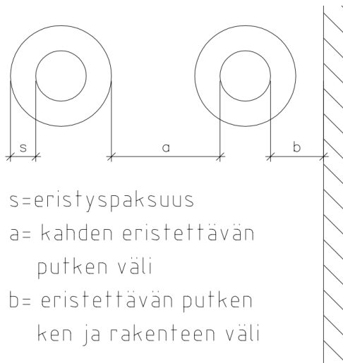
Kuva 1. LVI-ohjekortti 06-10105. Tilavarausohjeet. Kuvan 1 mittapisteet. [4, s. 2.]
