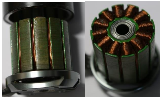
Kuva 2. Puretun moottorin staattori ja vihreä epoksiliima.
