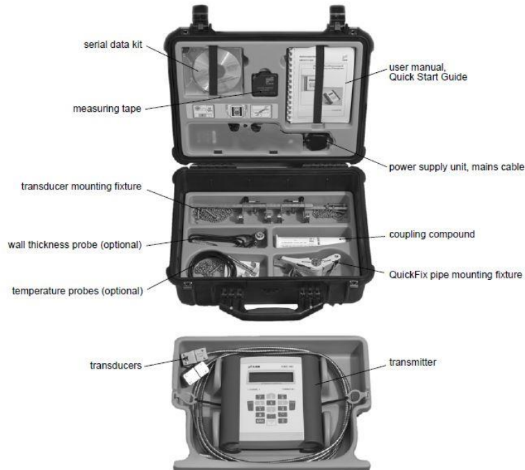
Kuva 12. Flexim Fluxus F601E-mittauslaite (Flexim 2015, 11).
