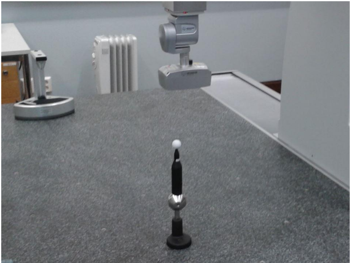
Kuva 4. Lasermittausanturi, sekä laserin kalibrintipallo ja säilytysteline
