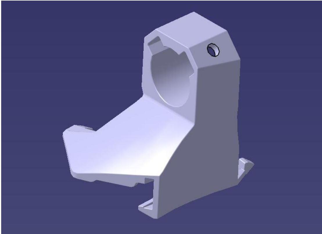
Kuva 29. Uuden valaisinkiinnikkeen viides mallinnusversio
