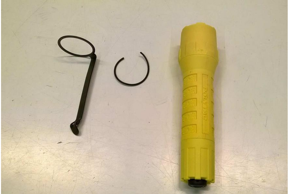
Kuva 18. Klipsi, rikkoutunut tiivisterengas ja valaisin
