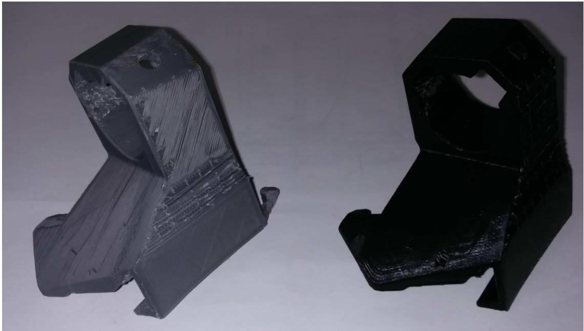
Kuva 31. Vasemmalla ABS- ja oikealla PLA-materiaalista valmistettu testikappale
