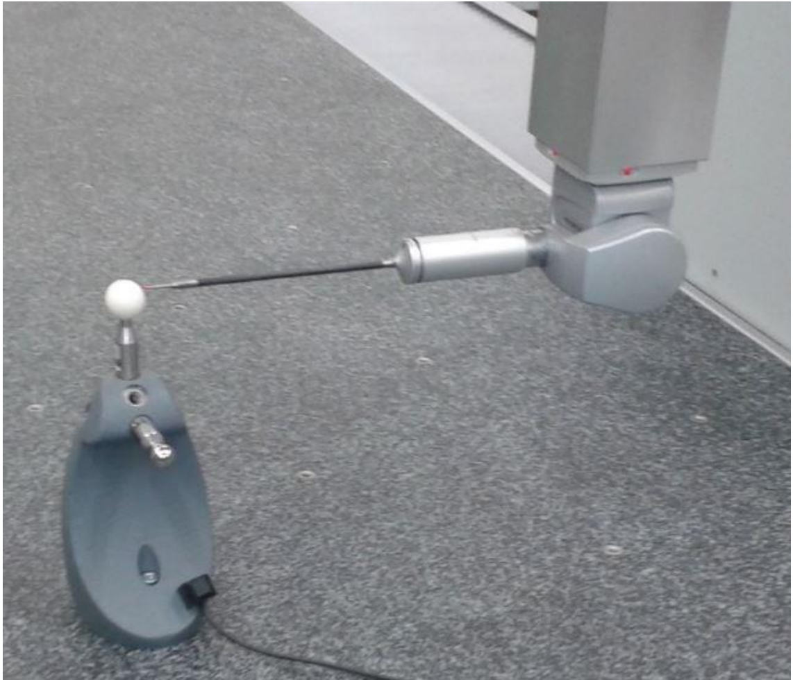
Kuva 5. 90 asteen kulmaan käännetyn koskettavan mittapään kalibrointi
