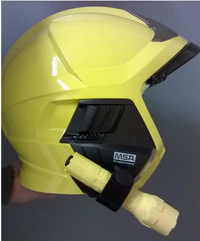
Kuva 19. Valaisin asennettuna palokypärään
