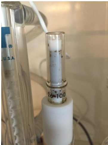
Kuva 13. Likaantunut palauteventtiili, joka on vielä tislaukskolonnissa kiinni.
