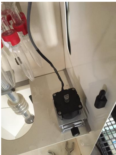
Kuva 15. Tislauskolonnin epäkuuntoinen askelmoottori.
