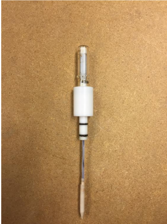
Kuva 14. Likainen palauteventtiili irrotettuna kolonnista.
