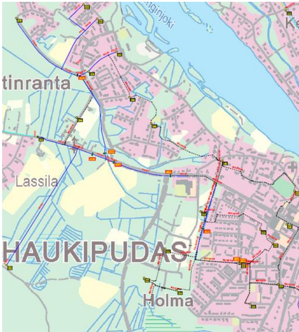
KUVA 11. Haukiputaan keskustan länsipuolen keskijänniteverkkoa
