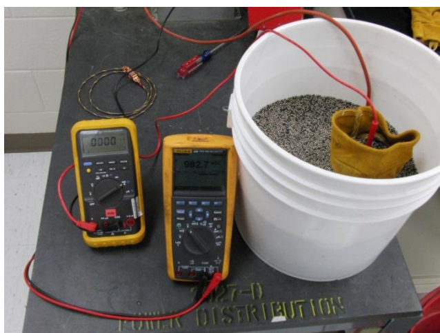
Kuva 27. Hansikkaan sähkön eristävyys testaus (Backstrom ym. 2011, 44).
