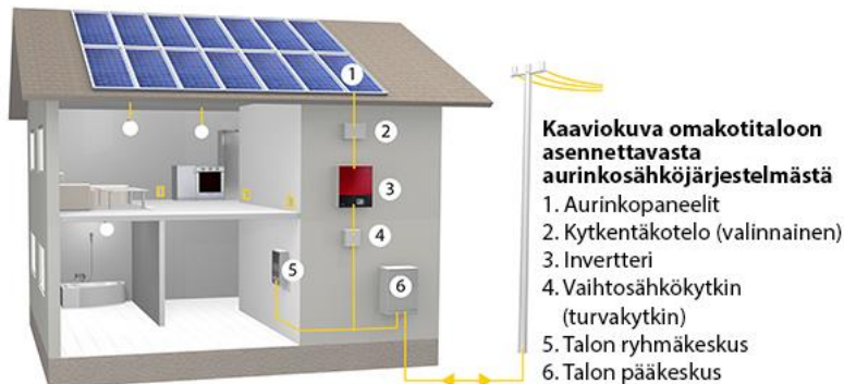
Kuva 5. Verkkoon kytketyn pientalon aurinkosähköjärjestelmän kokoonpano (Verkkoon liitetty aurinkosähköjärjestelmä 2016).
