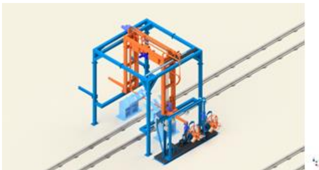
Kuvio 12. Kehävanteutus ja metallikela aseman jälkeen (Pesmel 2017).
