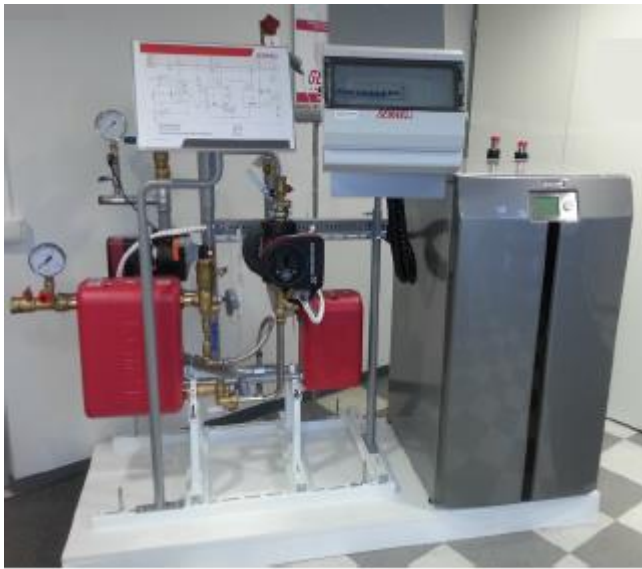
Kuva 11. Tehdasvalmisteinen kaukolämmönjakokeskus yhdistetty lämpöpumppuun /17/.
