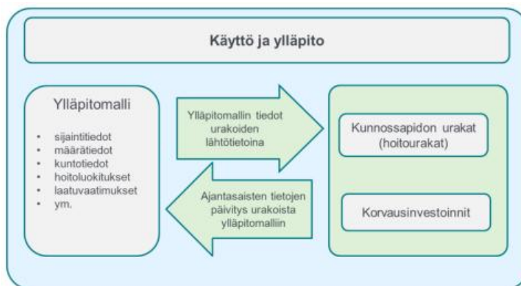
Kuvio 6. Ylläpitomalli hankkeen ylläpitovaiheessa (BuildingSMART Finland 2015d)
