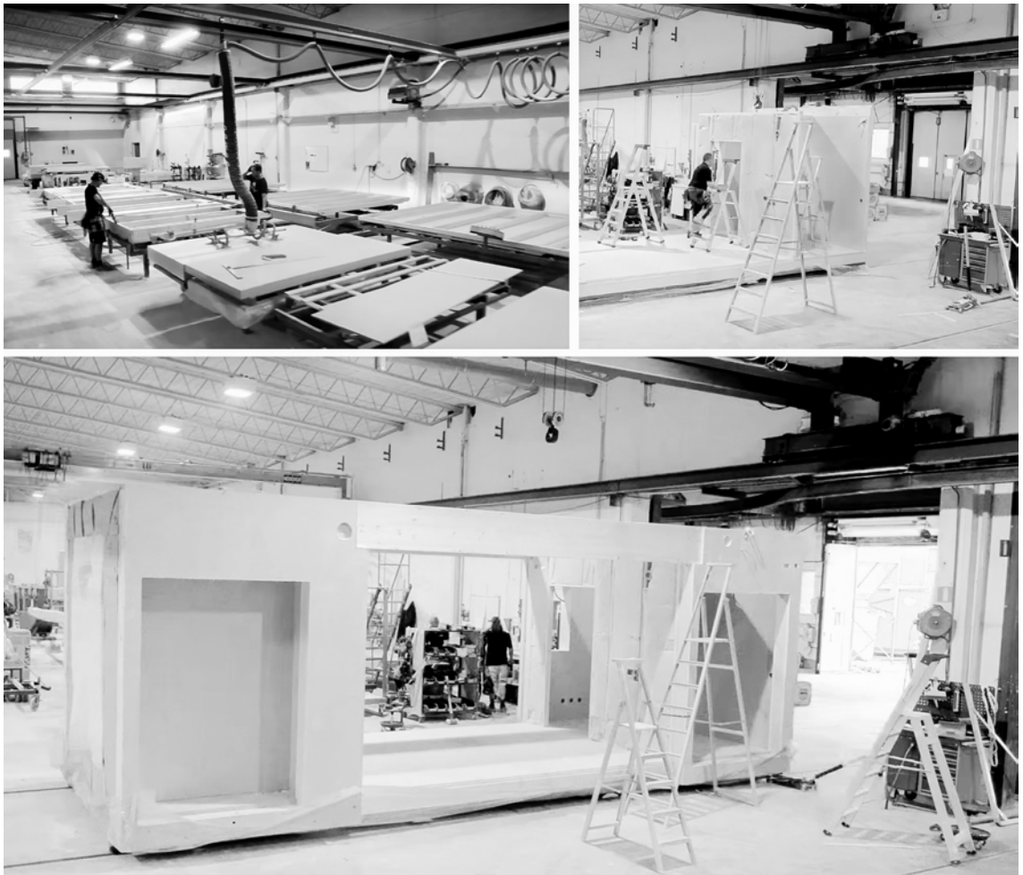
KUVA 34. Tilaelementtien rakentamisvaiheita Moelven tilaelementtitehtaalla (83, muokattu).
