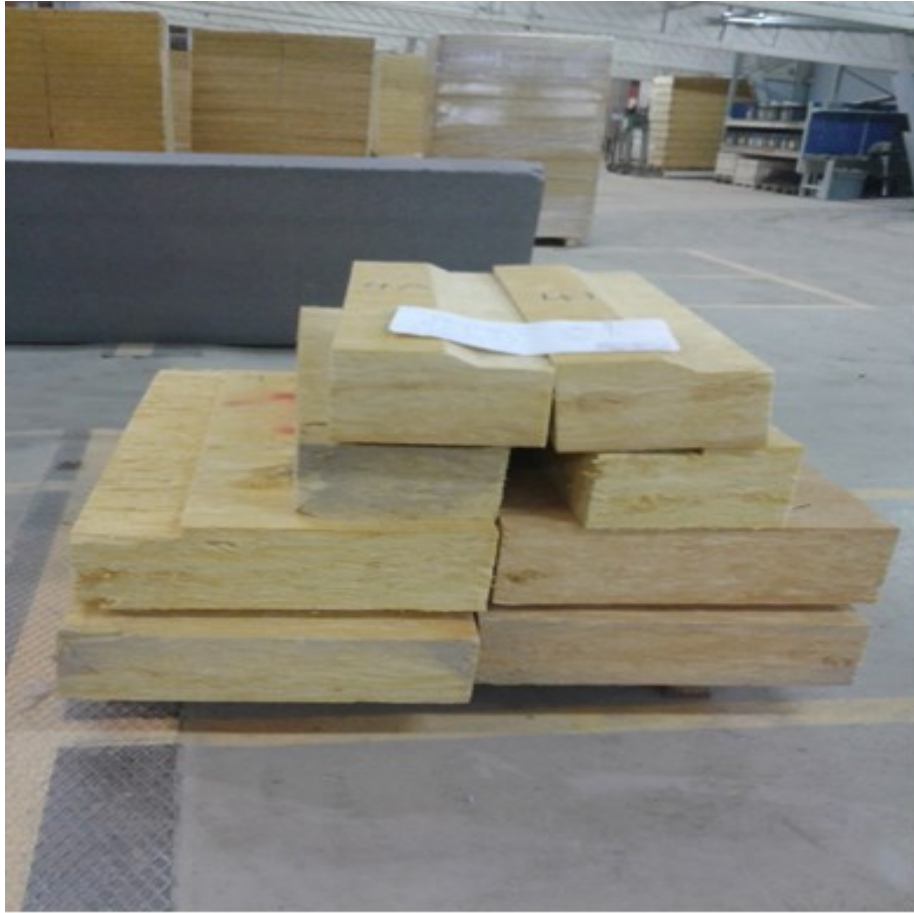
Kuva 4. Esivalmistellut eristeet odottamassa asennusta. Asennusohje eristeiden päällä.
