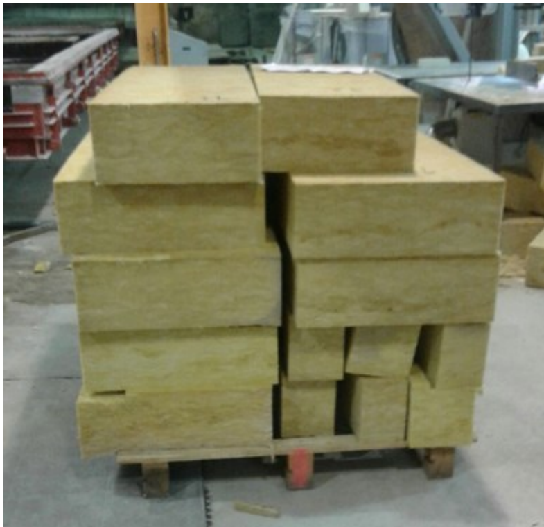
Kuva 7. Toisessa testissä esivalmisteltiin kaikki elementtiin tulevat eristeet.
