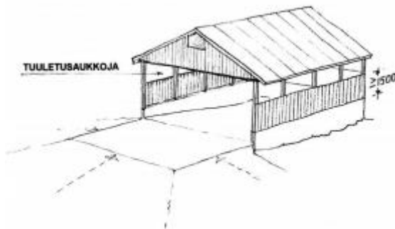
KUVIO 3. Lantalan tuuletusaukot ja betonisen seinän korkeus (MMM-RMO, C 4)
