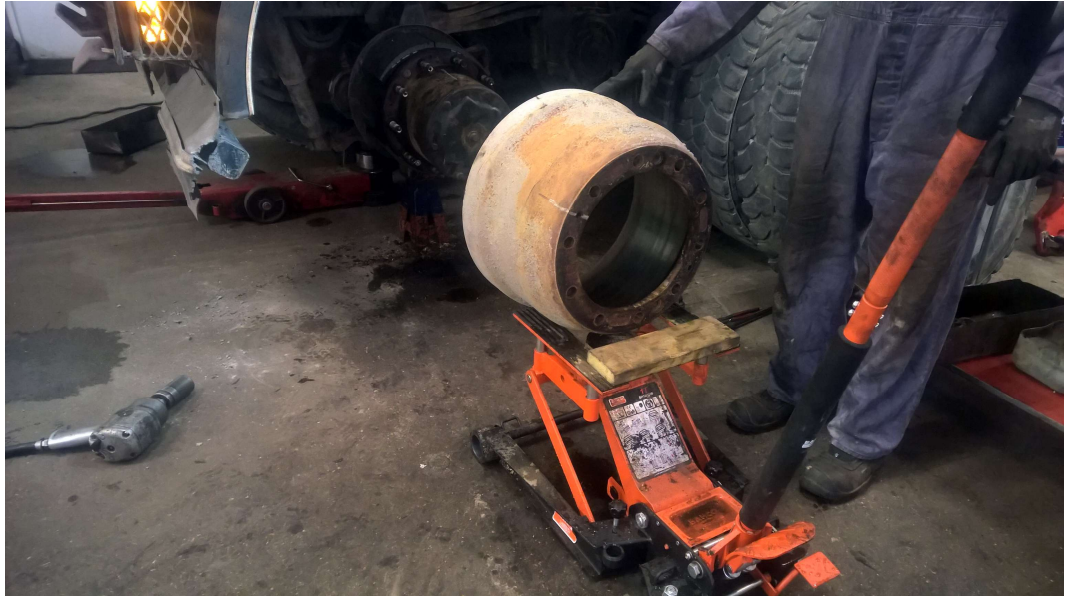
KUVA 1. Napojen ja jarruosien nostotunkki
