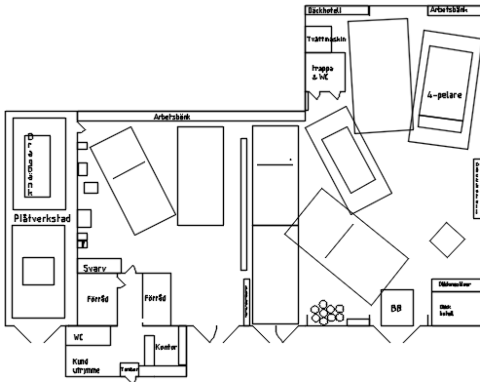
Figur 4. Servicegruppen delvis övertäckt, bromsänken flyttad, körbanslyft tillsatt.
