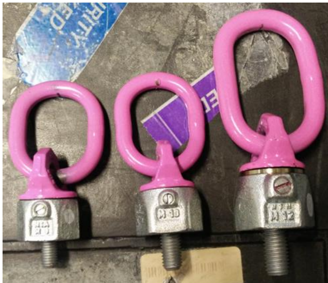
Figur 23. Skruvbara lyftöglor av olika storlekar.
