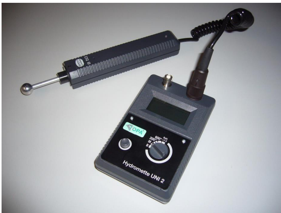
Figur 2. Ytfuktmätare som användes vid konditionsgranskningen
