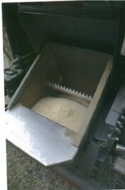
Kuva 4. Jauhatusauton terässuppilo (Vilkuna 2015, 58).
