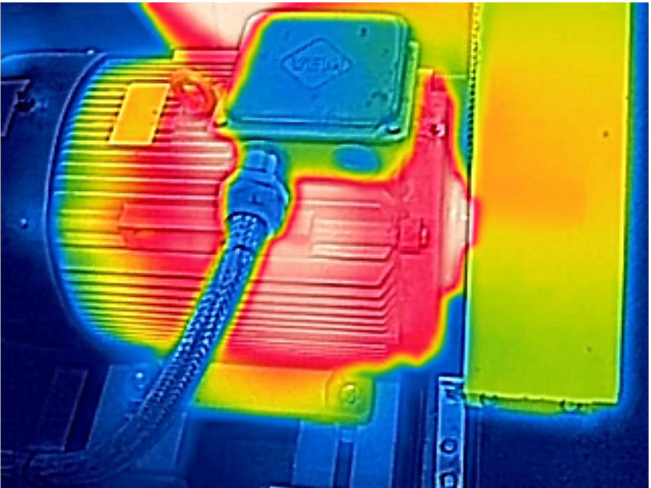
KUVA 10. Sähkömoottorista otetut erilliset kuvat yhdistettynä MSX-muodossa
