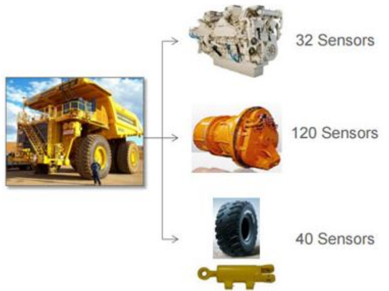
Kuva 2. Komatsun valmistamassa itseajavassa kuorma-autossa on noin 200 sensoria (Postcapes 2017).
