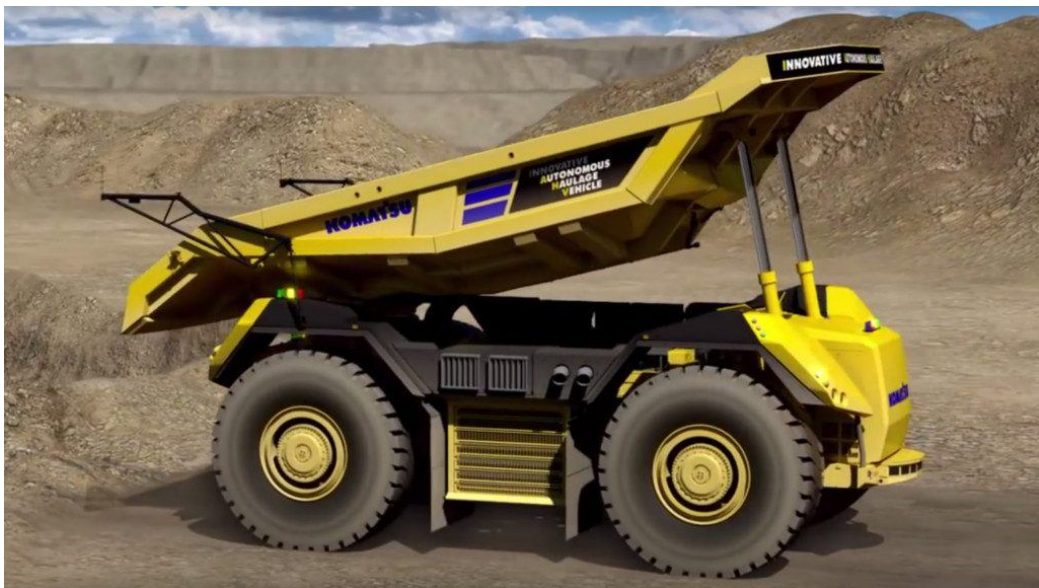
Kuva 5. Komatsun kehittämä innovatiivinen kuorma-auto ei kuljettajaa kaipaa (Tamminen 2016).
