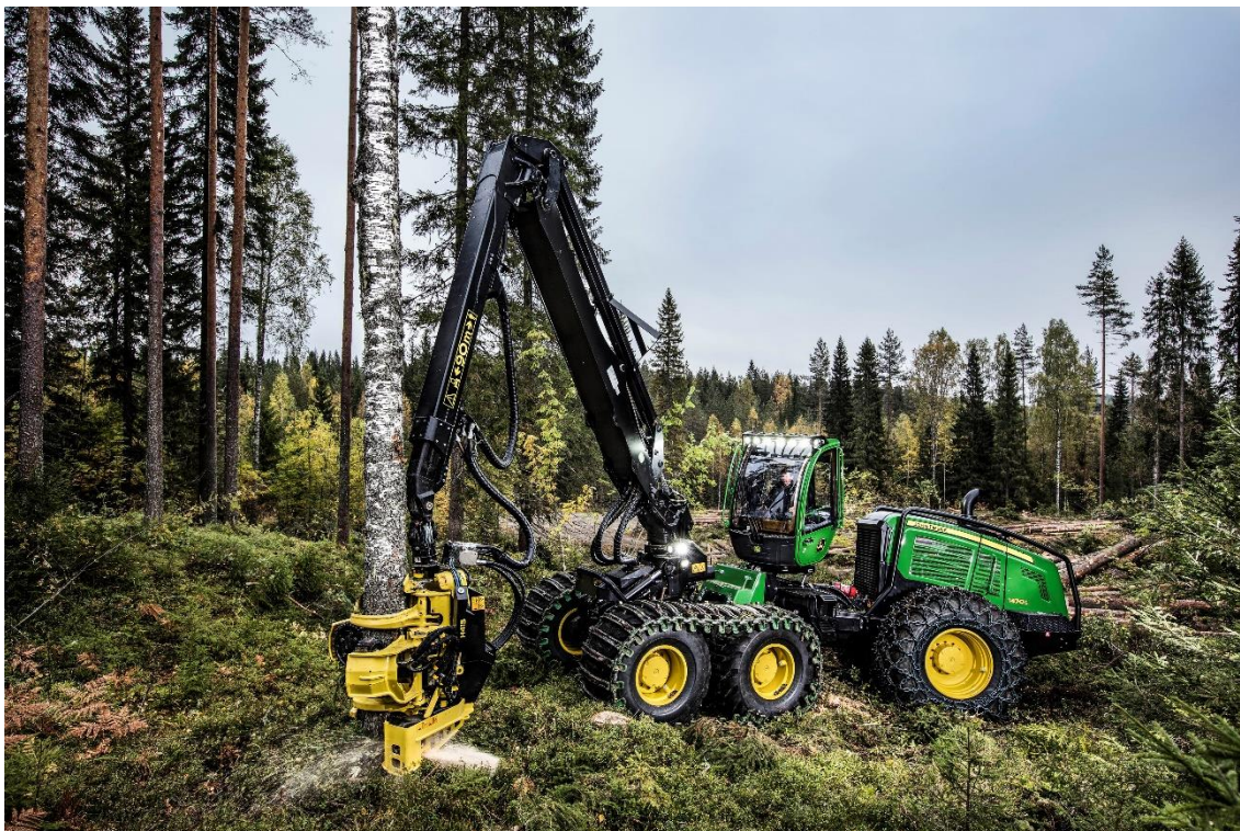
Kuva 3. John Deere 1470G-pyöräharvesteri H415-harvesteripäällä varustettuna [6].
