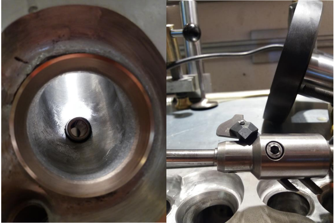
KUVA 16. Koneistettu seetirengas ja käytetty R-terä
