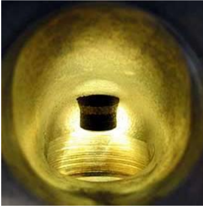
KUVA 14. Volvo 530:n vakio imukanava
