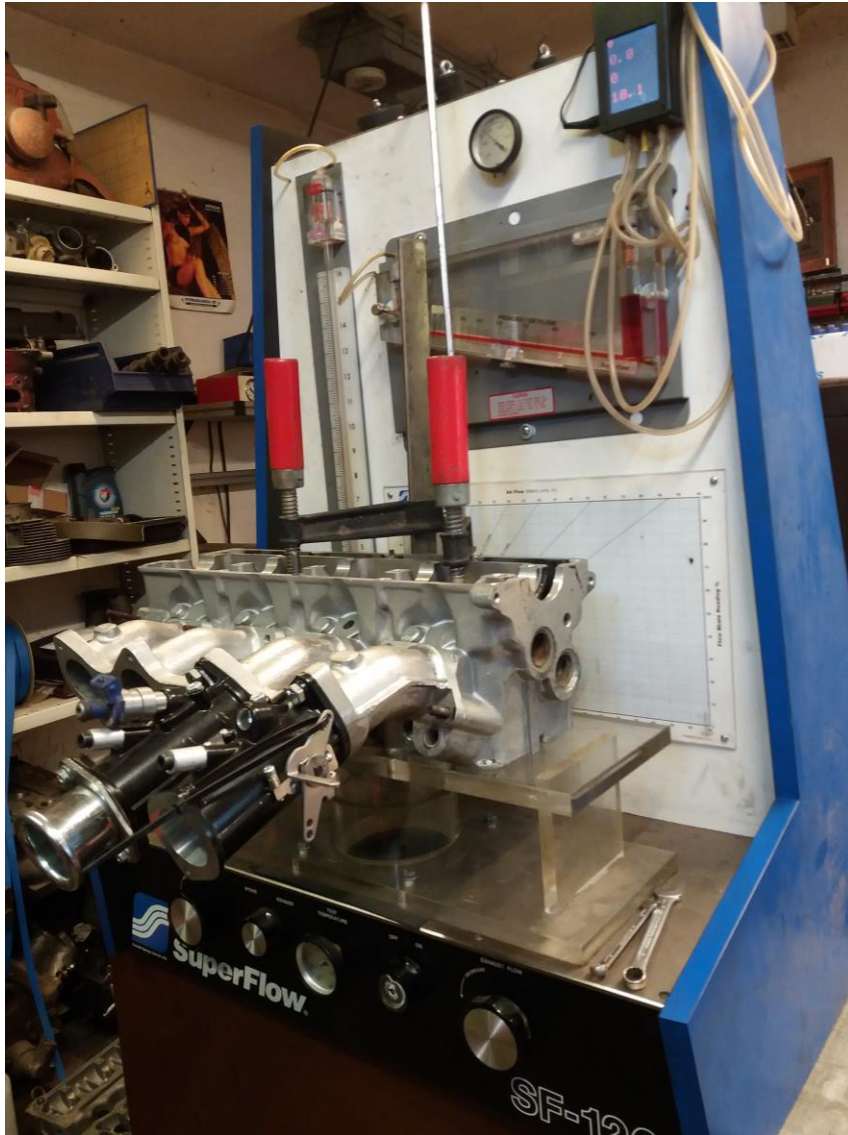
KUVA 20. Sylinterikansi imusarjoineen kiinnitettynä virtauspenkkiin
