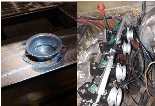
KUVA 19. Valmistettu imutorvi ja muut osat asennettuna ajoneuvoon.
