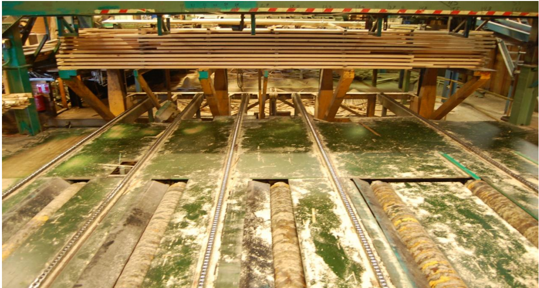
Kuva 12. Kuorma tulee hissilavalta ketjukuljettimia pitkin
