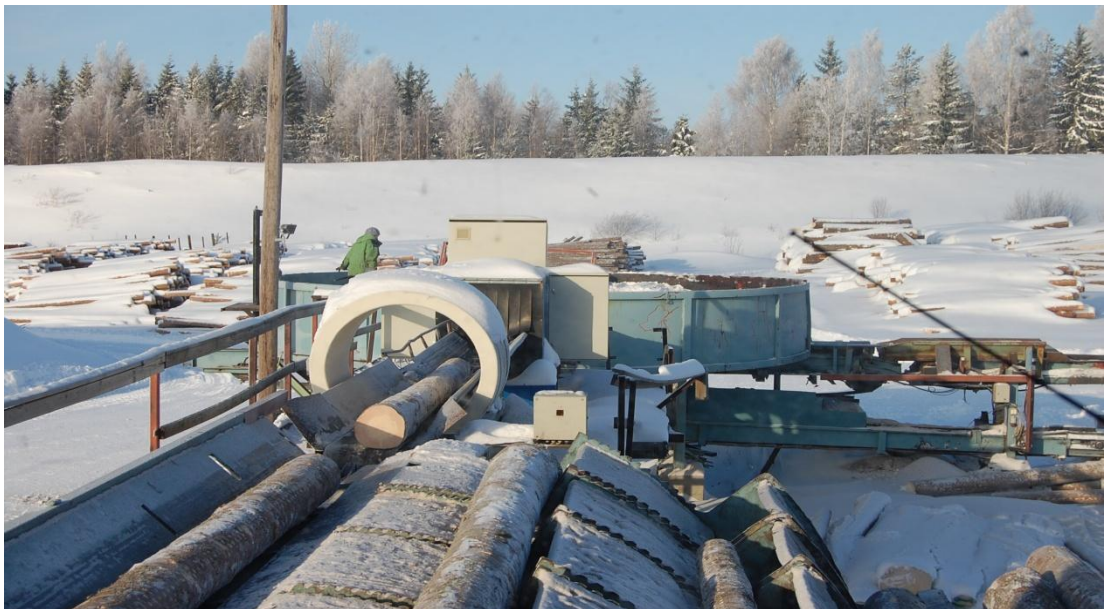
Kuva 1. Työntekijä poistamassa jumissa olevaa tukkia kääntäjästä
