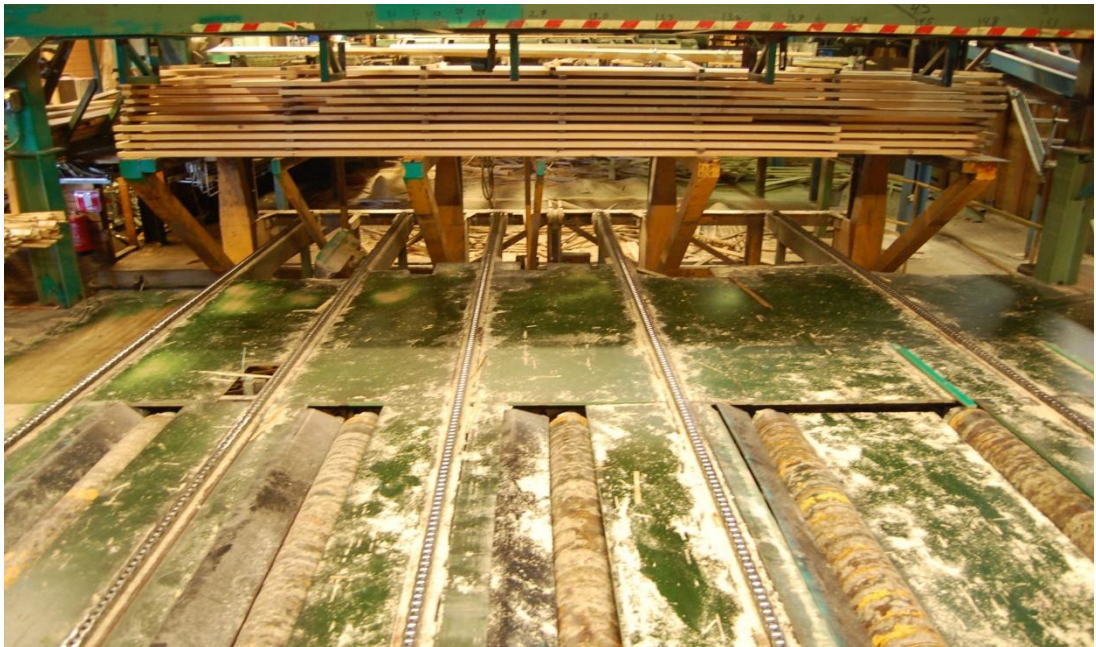
Kuva 6. Kuivaamokuorma syntyy hissilavan päälle
