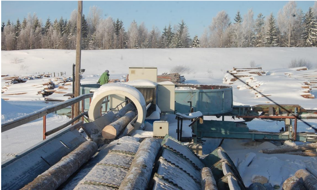
Kuva 5. Näkymä tukkilajittelun valvomosta ja jumiin jääneen tukin irrotus kääntäjästä
