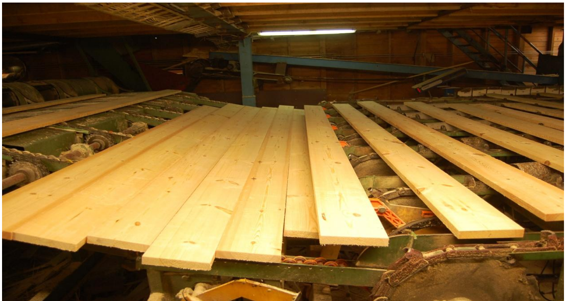
Kuva 10. Annostelija toiminnassa ja jokainen kappale menee omaan kolaväliin
