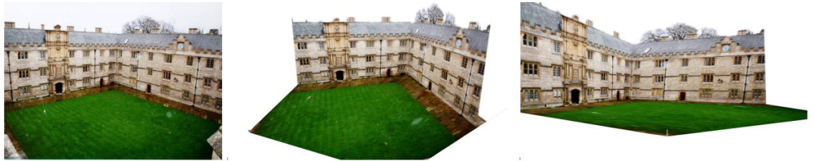
KUVA 16 Yhdestä kuvasta luotu kolmiulotteinen pop-up malli (Hoiem ym. 2015, 6)
