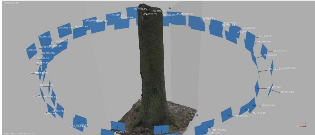
KUVA 2 Kameroita edustavat siniset suorakulmiot sijoitetaan automaattisesti
