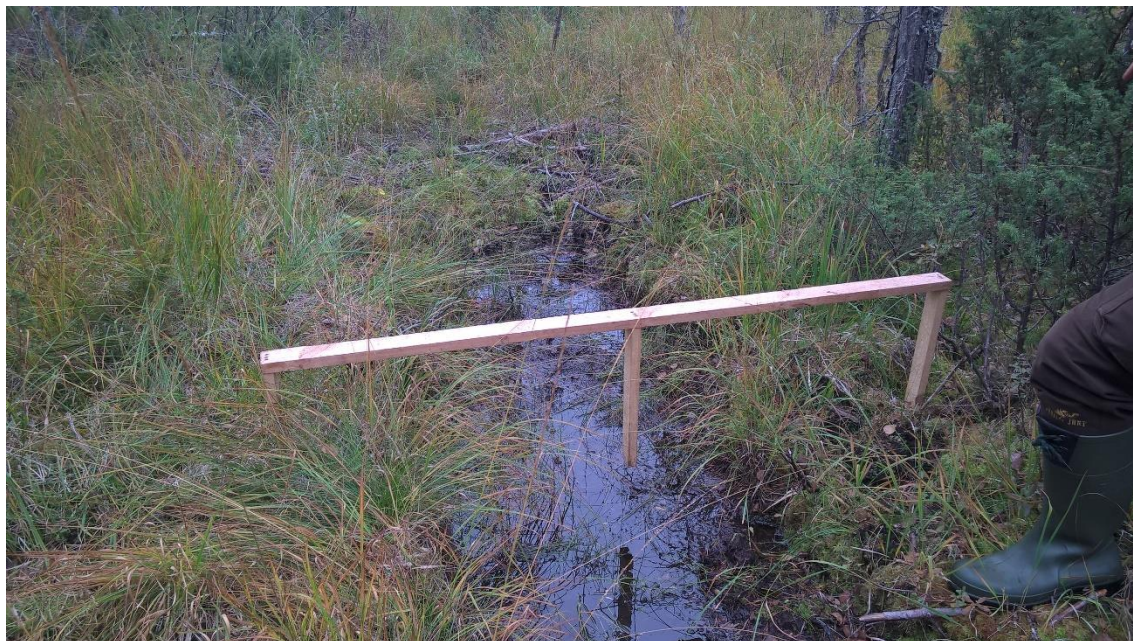
Kuvio 5. Ajourapinaumien syvyyden mittaamisessa käytetty apuväline
