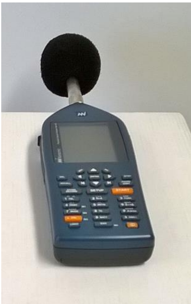
Kuvio 19. Norsonic nor 140 -mittalaite mittaustilanteessa seinän vieressä
