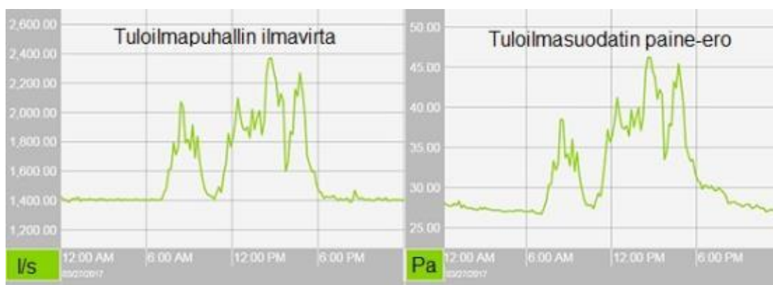
Kuva 13. Tuloilmavirta ja tuloilmasuodattimen yli oleva paine-ero ajan suhteen 27.3.2017
