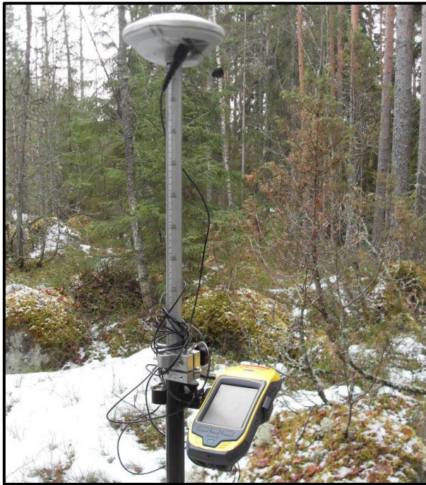
Kuva 12. Trimble-tarkkuuspaikannin ulkoisella antennilla (Väyrynen 2017).
