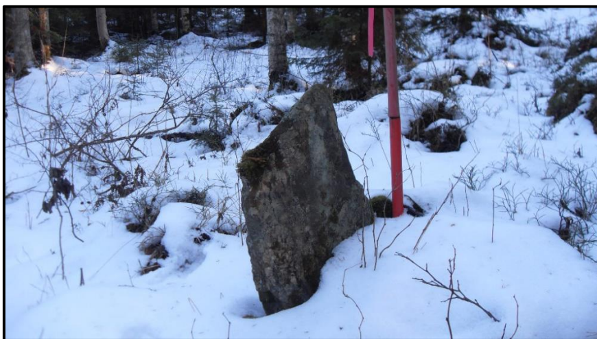
Kuva 13. Yksikivinen pyykki. Paikannuslaitteeseen tallennetaan pyykin koordinaatti pyykin kärjestä (Väyrynen 2017).
