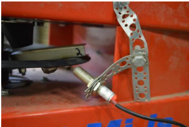
Kuva 5. APV piensiemenvittimeen kiinnitetty kierroslukumittari.
