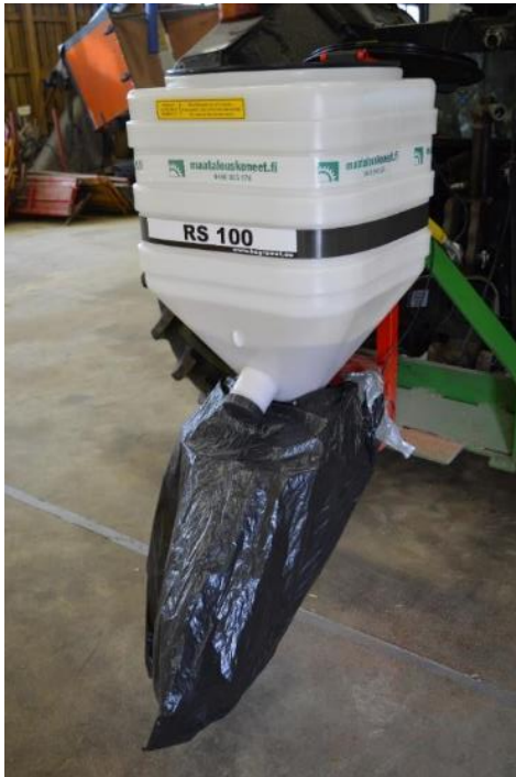
Kuva 1. Muovipussi asennettuna RS 100 pienen siemenlevittimeen.
