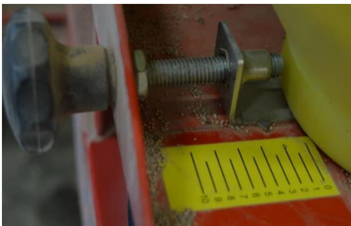
Kuva 7. APV piensiemenvittimen pohjaluukun aukon säätö.
