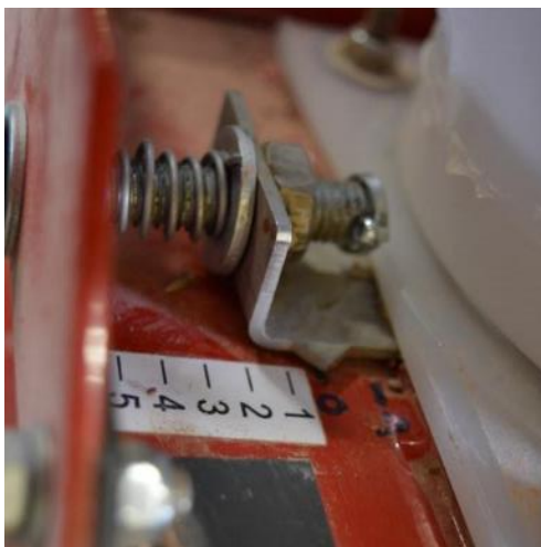
Kuva 2. RS 100 pienen siemenlevittimen pohjaluukun asteikko.
