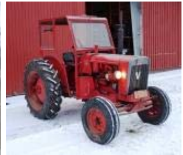
Kuva 6.7. a-b) Biodieseliä ja tuulta käyttävä hybridilaiva Vaasassa. [2008] c) Biodieseliä käyttävä Valmetin traktori Haapajärven ammattiopistolla käyttää opiston itse rypsiä tuottamaa biodieseliä. [2007]
