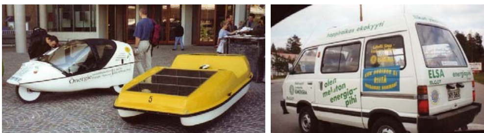
Kuva 7.14. Esimerkkejä ZEV-ajoneuvoista: a) Aurinkosähköistetty vene Eurosun96-konferenssin näyttelyssä Freiburgissa Saksassa vieressään Twike-merkinen katettu polkupyörä. [1996] b) Jyväskylän Energian suomalainen Elcat-konversiosähköauto. Auto on konvertoitu Subaruun pakettiautosta. [1997]
