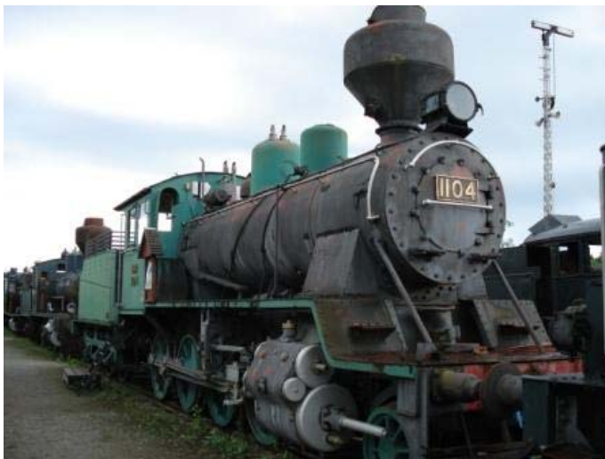
Kuva 6.22. Kaksoispaisuntahöyrykoneella eli kombikoneella varustettu, Tampereella vuonna 1943 valmistettu halkokäyttöinen veturi Tk3 eli Pikku-Jumbo Haapamäen höyryveturipuistossa. Tämä veturityyppi oli käytössä vuosina 1928-1975. [2007]
