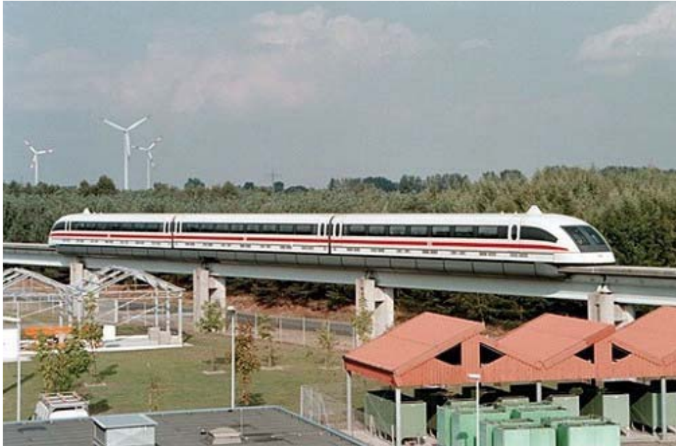
Kuva 2.138. Tuulisähkökäyttöinen Transrapidin maglev-juna 31,5 km pitkällä testiradallaan Saksassa. [© Transrapid 2007]
