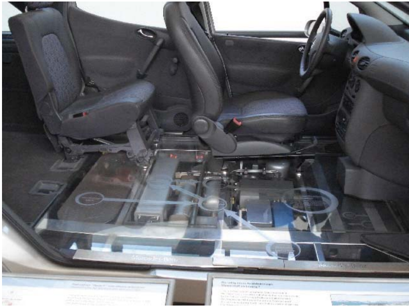
Kuva 2.58. Daimler-Benzin Mercedes A-mallin pohjalta tekemä metanolikäyttöinen 75 kW:n Necar-5 -polttokennokoeauto vuodelta 2000 Münchenin liikennetekniikan museossa. Polttoaine- ja polttokennolaitteisto mahtuu kokonaan lattian alle säästäten tilaa polttomoottoriversioon verrattuna. [2007]
