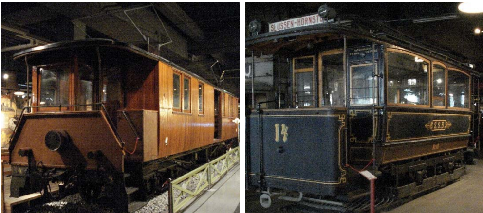
Kuva 2.84. Varhaisia ruotsalaisia vesivoimakäyttöisiä raideajoneuvoja Tukholman liikennelaitoksen museossa: a) Sähköjunan vaunu vuodelta 1893. b) Sähköraitiovaunu vuodelta 1901. Molemmat saivat sähkön radan yläpuolisista kaapeleista. [2007]
