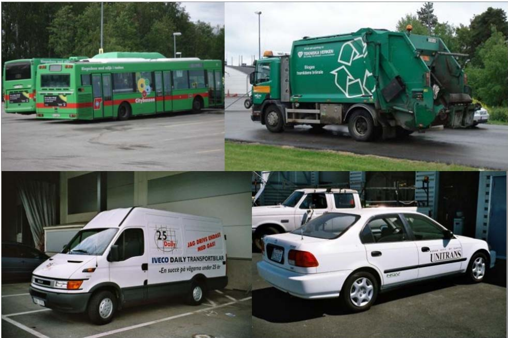
Kuva 6.1. Metaanimonofuel-autoja: a) Eskilstunan biokaasubusseja hidastankkauksessa bus- sivarikolla. [2009] b) Biokaasujätetrekka nopeatankkauksessa Linköpingissä. [2009] c) Biokaasu- pakettiauto Iveco Daily CNG Tukholmassa. [2004] d) Maakaasuhenkilöauto Honda Civic GX Davisissä Kaliforniassa. [2004]
