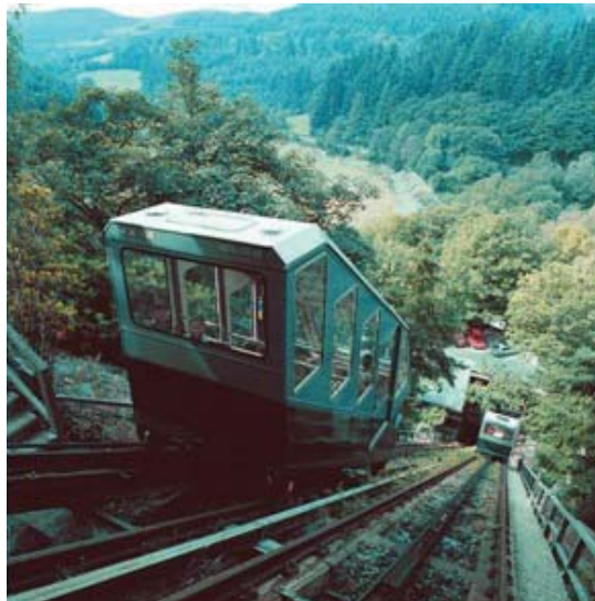
Kuva 2.9. Suoraa vesivoimaa hyödyntävä rinneraitiovaunu Centre for Alternative Technology:ssä Walesissa (CAT 2007).
