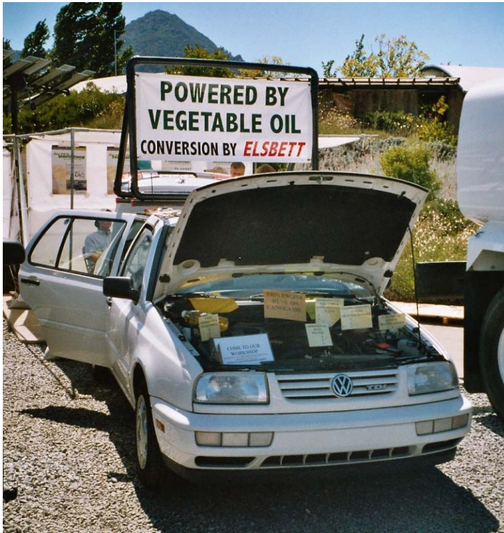
Kuva 6.8. Puhdasta kasviöljyä PPO100 käyttävä saksalaisella Elsbettin konversiosarjalla konvertoitu VW Jetta näytteillä uusiutuvan energian markkinatapahtumassa Hoplandissa Kaliforniassa. Moottoriin on lapuilla merkitty konversiossa lisätyt/vaihdetut komponentit. [2004]
