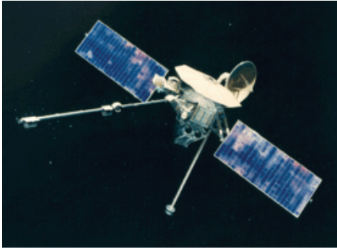
Kuva 2.136. Vuonna 1973 lähetetty NASA:n Mariner 10 oli ensimmäinen auringon fotonisäteilypainetta aurinkopurjeella hyödyntänyt avaruusluotain. Se hyödynsi myös gravitaatiolinkoa ja avaruusaluksille tavanomaiseen tapaan se tuotti sähköä elektroniikkaansa aurinkopaneeleilla. [ @ NASA ]
