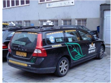
Kuva 6.12. Multifuel-takseja: a) Fiat Siena TetraFuel Manauksessa Brasiliassa. Se pystyy käyttämään biokaasua, maakaasua, 100 % etanolia ja bensiiniä. [2006] b) Volvo V70 FT 2.5 GAS Tukholmassa. Se pystyy käyttämään biokaasua, maakaasua, 85 % etanolia ja bensiiniä. [2009]
