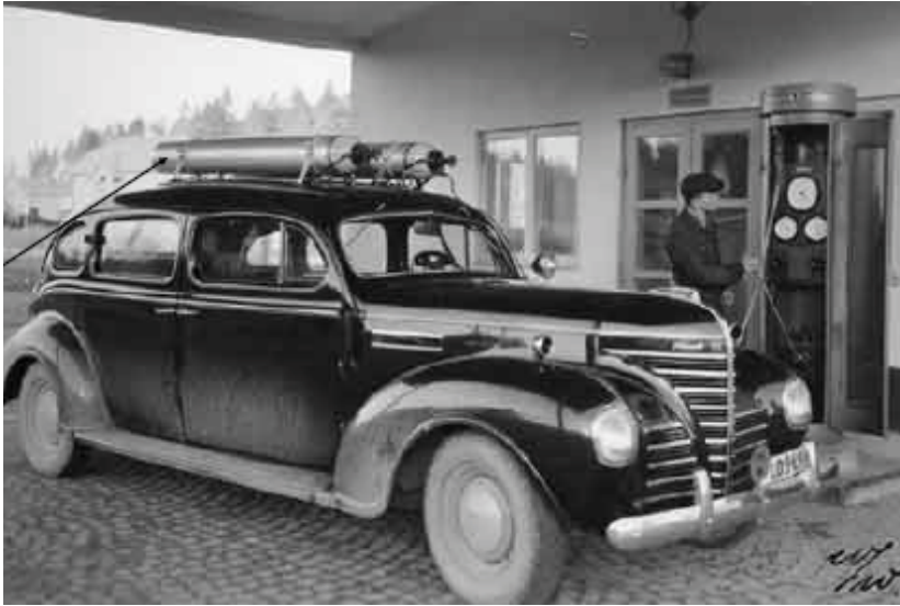
Kuva 2.131. Volvon biokaasuauto Ruotsissa 1940-luvulla. Nuoli osoittaa katolla oleviin kompressoitun biokaasun (CBG) tankkeihin. (Holm 2006)
