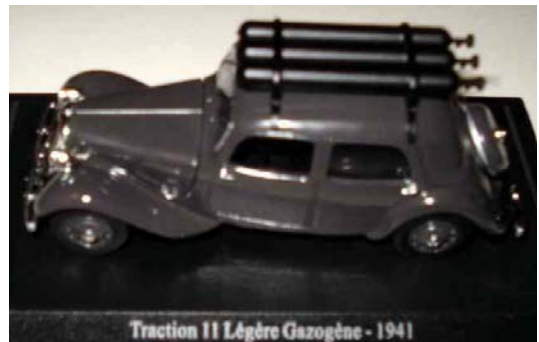
Kuva 2.62. Kompressoitua kaupunkikaasua käyttävän vuosimallin 1941 Citroen-henkilöauton pienoismalli. Katolle asennettava kolmen painepullon muodostama kaasuvälikon ei vie tilaa auton sisältä. [2008]
