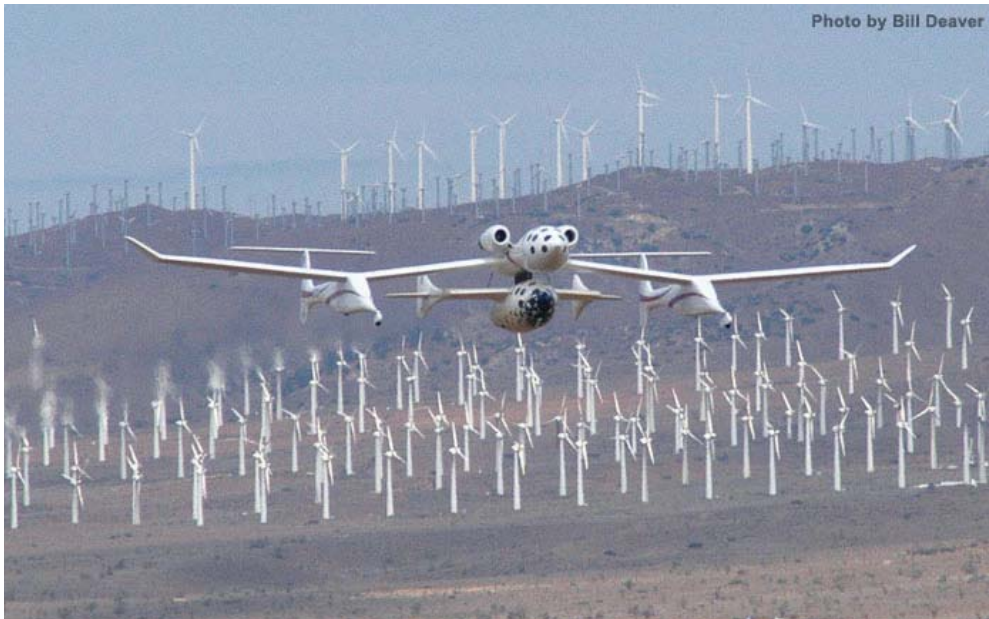
Kuva 3.4. Kumi- ja ilokaasukäyttöisellä rakettimoottorilla varustettu SpaceShipOne-avaruusalus White Knight -kantosuihkukoneen alle kiinnitettynä Mojaven tuulipuiston yläpuolella Kaliforniassa. [© Bill Deaver/Scale Composites picture gallery/scaled.com 2004]
