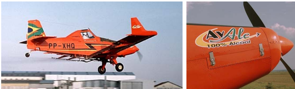
Kuva 6.2 Brasilialaisen Embraer-yhtiön sarjavalmistuksessa oleva E100-etanolikäyttöinen Ipanema-lentokone [© Embraerin kuva-arkisto 2006].
