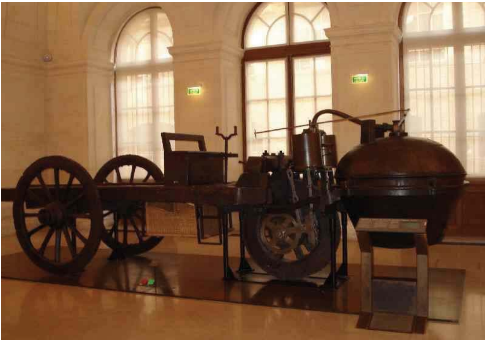
Kuva 2.36. Ranskalainen Joseph Cugnot rakensi vuonna 1769 maailman ensimmäisen lämpövoimakonekäyttöisen auton. Se toimi sekä kivihieillä että puulla ja oli tarkoitettu tykin vetäjäksi. Ensimmäinen auto ei ole säilynyt, mutta hänen vuonna 1770 rakentamansa toinen auto on esillä Musée des Arts et Métiers:ssä Pariisissa. [2007]
