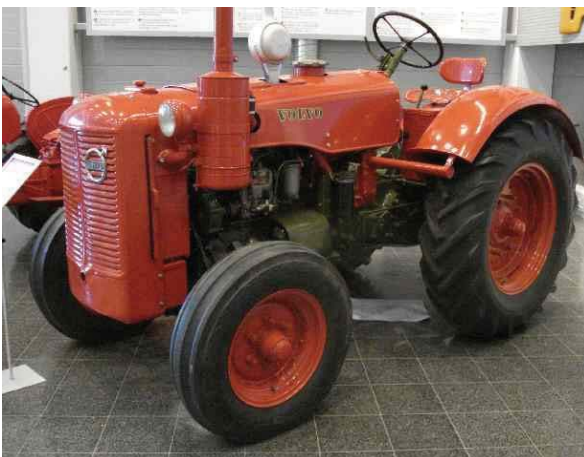
Kuva 2.53. Hesselman-moottorilla varustettu vuosimallin 1944 Volvo T43-traktori, joka pystyy mm. etanolin käyttöön, Valtran traktoritehtaan näyttelyssä Suolahdella. [2008]
