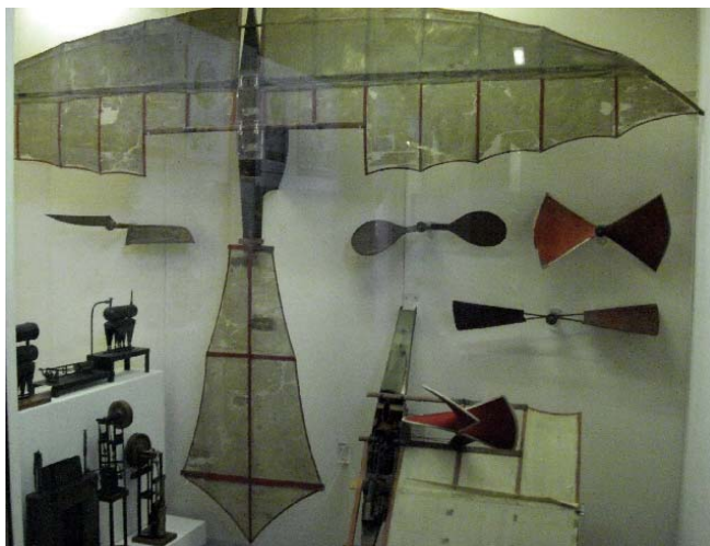
Kuva 2.76 Maailman ensimmäinen lentokone Lontoon tiedemuseossa. John Stringfellow:n mallilentokone lensi ensi kerran vuonna 1848. Sen etanolikäyttöinen moottori on vasemmalla ylähyllyllä. Muut kuvassa näkyvät osat ovat peräisin Stringfellow:n vanhemmista ja myöhemmistä koneista. [2007]
