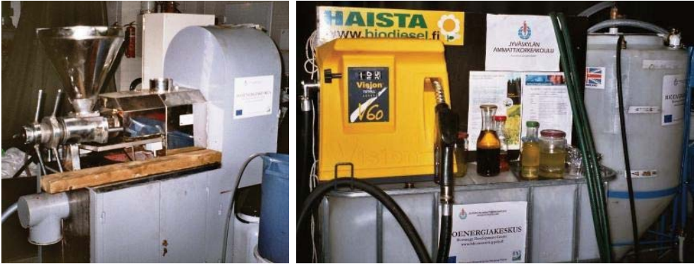
Kuva 5.1. Öljynpuristin (a) sekä amerikkalainen biodieselin kotituotantolaitteisto FuelMeister ja tankkauslaite (b) opetuskäytössä Jyväskylän ammattikorkeakoulun bioenergiakeskuksessa Saarijärvellä. [2006]
