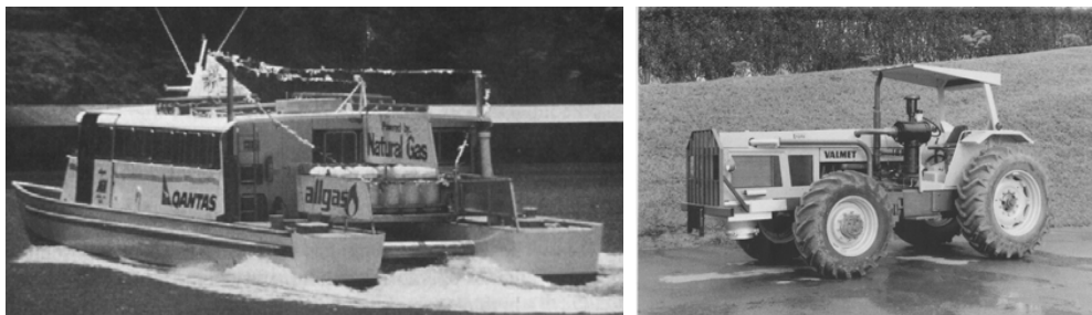
Kuva 6.14. Dualfuel-ajoneuvoja: a) Sydneyssä liikennöivä maakaasukäyttöinen dualfuel-moottorivene (Stephenson 1991). b) Valmetin Brasilian tehtaiden 1980-luvulla valmistama puukaasukäyttöinen dualfuel-dieseltraktori. [© Valtra].
