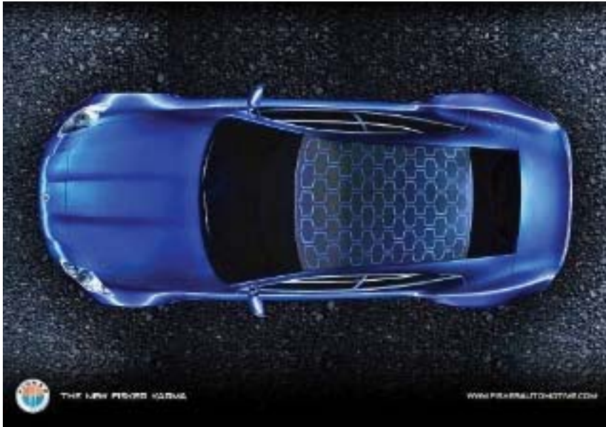
Kuva 2.100. Uudessakaupungissa vuodesta 2009 alkaen valmistettava Fisker Karma on ladattava ottosarjahybridi, jossa on mukana aurinkopaneelikatto (Fisker 2009). [© Fisker Automotive]
