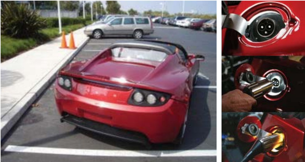
Kuva 2.95. a) Pakoputket puuttuvat 248 hv:n Tesla Roadster -aurinkosähköautosta. [Wikipedia, Creative Commons Attribution ShareAlike 2.0 License] b-d) 56 kWh Li-ioniakuston lataus (Tesla 2007).
