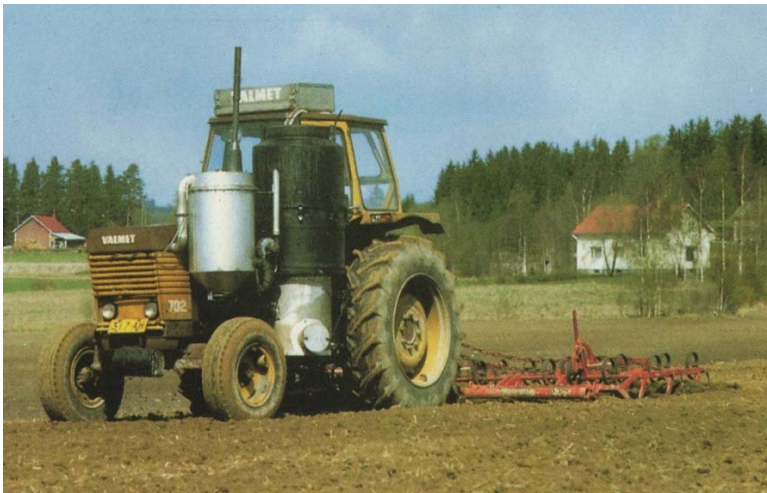
Kuva 2.70 Valmetin dualfuel-puukaasukonvertoitu dieseltraktori Vakolan testeissä vuonna 1979. [© Vakolan arkisto]
