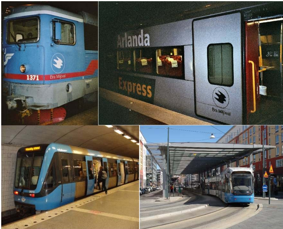
Kuva 6.20. Kaikki Tukholman sähköinen joukkoliikenne kulkee Ruotsin luonnonsuojeluliiton sertifioimalla ”Bra miljöveral”-ekosähköllä eli vesi-, tuuli- ja biovoimalla: a) paikallisjunat, b) nopeat lentokenttäjunat, c) metrot ja d) raitiovaunut. Junat ja raitiovaunut saavat sähkön radan yläpuolisista kaapeleista ja metro radan kolmannesta raiteesta. Myös Ruotsin valtion rautatiet käyttää vain Bra miljöveral -ekosähköä. [2004-2007]
