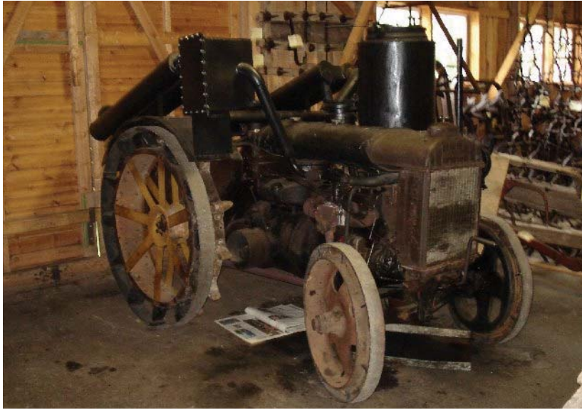
Kuva 2.67. AKMO-puukaasuttimella varustettu käyttökuntoinen Fordson-F-traktori Eurajoen maatalousmuseossa. [2007]
