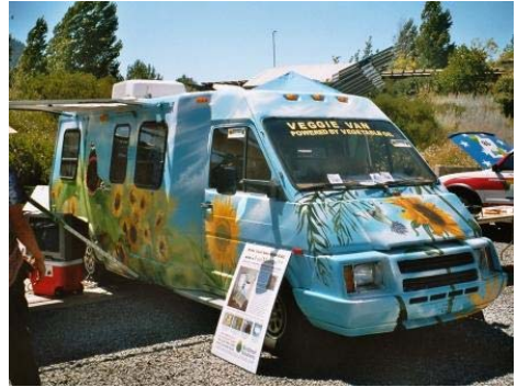
Kuva 6.6. Biodieselautoja: a) Tehdasvalmisteinen Peugeot 308 Biodiesel Frankfurtin autonäyttelyssä. [2007] b) Australialaisesta Winnebago-asuntoautosta konvertoitu pikaravintoloiden jäterasoilla kulkeva pakettiauto ”Veggie Van” Hoplandissa Kaliforniassa uusiutuvan energian messuilla. [2004]
