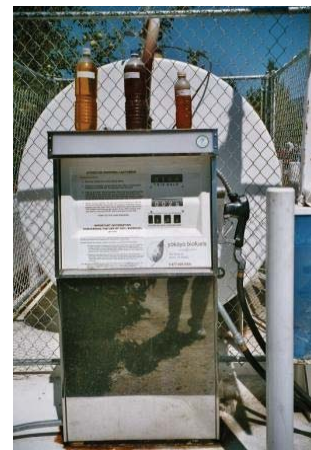
Kuva 2.125. Biodieselosuuskunnan Yokayo Biofuels ylläpitämä yleinen tankkausasema Hoplandissa Kaliforniassa. Etualalla biodieselin käyttöön konvertoitu Nissan. Pumpun päällä on pulloissa kolme kasviöljylajia, joista biodieseliä osuuskunnassa tehdään. [2004]
