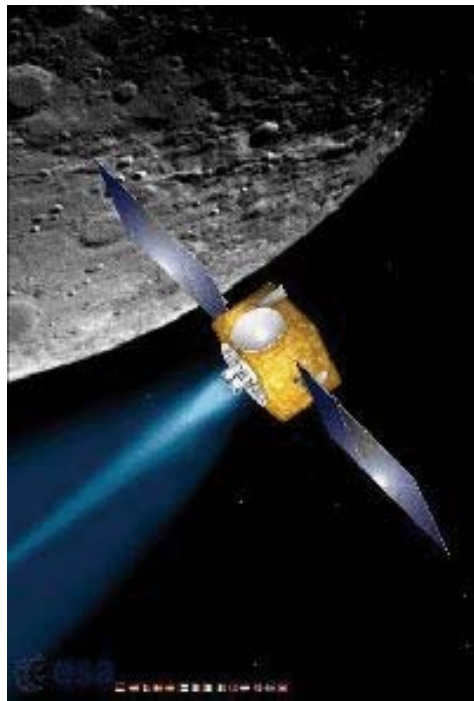
Kuva 2.30. a) Ionimoottori vuodelta 1970 Lontoon tiedemuseossa. [2007] b) Aurinkopaneelikäyttöinen Hall-ionimoottori ruotsalaisen vuonna 2003 lähetetyn Smart 1 -kuuluotaimen voimanlähteenä, piirros. [© ESA]
