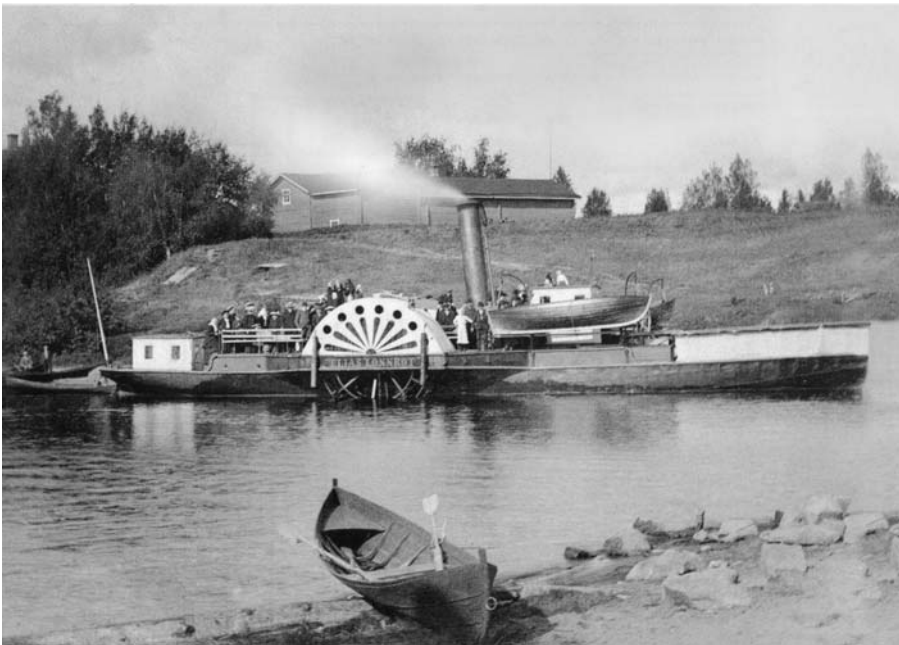
Kuva 2.40. Halkokäyttöinen 80 hv höyrykoneella varustettu siipirataslaiva Elias Lönnroth valmistui vuonna 1865 Pyhäjärven liikenteeseen. Vuosina 1890-1923 se liikennöi Keuruselällä ja romutettiin vuonna 1926. Kuva Museoviraston kokoelmista postin ehiökortista vuodelta 2006.
