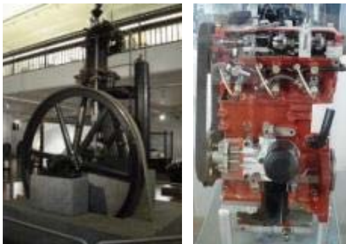
Kuva 2.56. a) Rudolf Dieselin ensimmäinen toimiva moottori vuodelta 1897 kävi kasviöljyllä ja on nyt esillä Deutsches Museumissa Münchenissä. b) Elsbettin ELKO-kasviöljydieselmoottori vuodelta 1987 Münchenin liikennetekniikan museossa. [2007]
