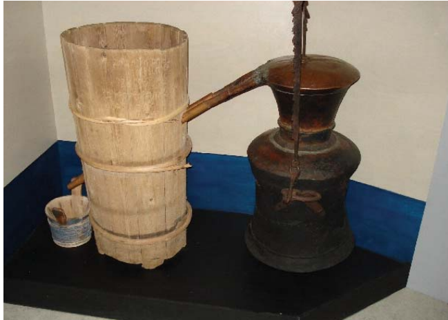
Kuva 2.75. Perinteinen pontikan tisluslaitteisto Keski-Suomen museossa Jyväskylässä. Oikealta vasemmalle: keittoastia, jäähdytysastia ja pontikan keräysastia. [2007]
