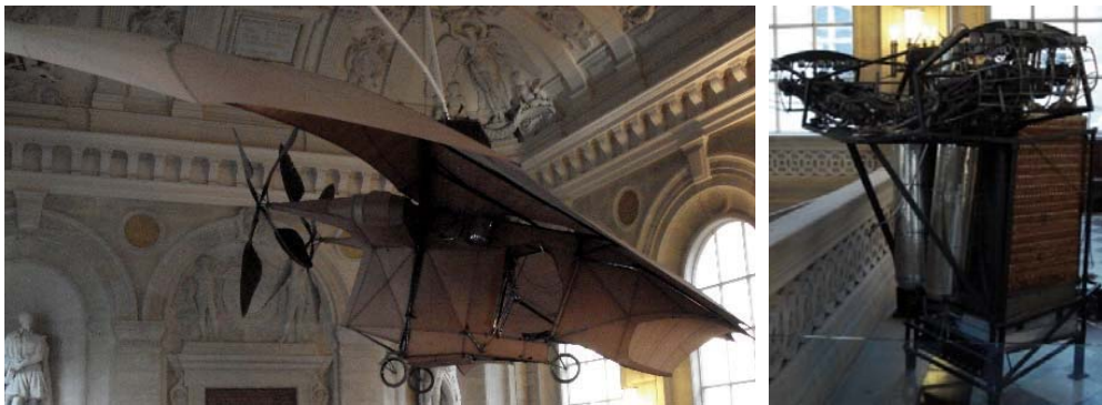
Kuva 2.77. Clément Aderin lentokone Avion III ja sen 2 x 15 kW:n etanolikäyttöinen moottori vuodelta 1897 Musée des Arts et Métiers:issä Pariisissa. [2007]
