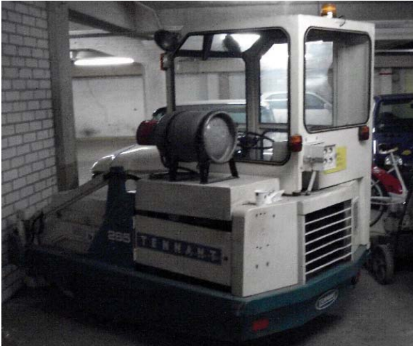
Kuva 3.30. a) Tenant-merkkinen nestekaasukäyttöinen lakaisukone Jyväskylässä. LPG-tankkina on kotitalous- ja teollisuuskäytöstä tuttu vaihtopullo. a) Vaihtopullon LPG-tuotetiedot sisältävä etiketti. [2006]
