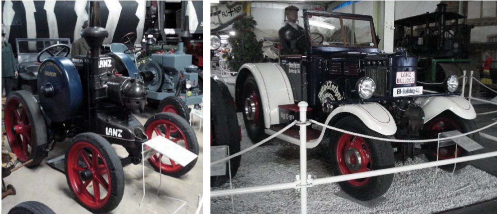
Kuva 2.55. Lanzin polttoainejoustavia hehkukupaajoneuvoja Sinsheimin autotekniikan museossa Saksassa: a) traktori vuodelta 1922, b) auto vuodelta 1944. [2007]
