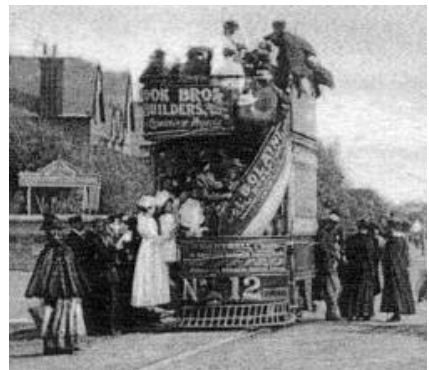
Kuva 2.61. Paineistettua kaupunkikaasua käyttävä raitiovaunu varustettuna Deutzin ottomoottorilla a) vuonna 1894 Dresdenissä Saksassa (Dresden 2007) ja b) vuonna 1901 Lythamissa Englannissa (Prentice 2007).
