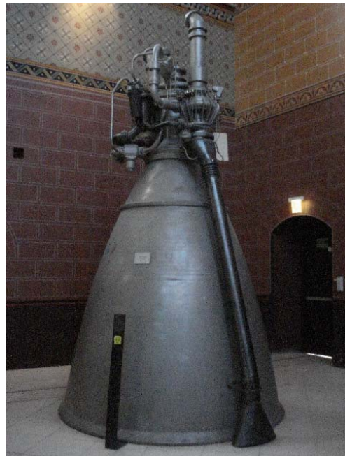
Kuva 2.50. Noin 10.000 MW tehoisia LH/LO 2 -käyttöisiä rakettimoottoreita: a) NASAn Apollo-lentojen Saturn V -kantoraketin J2-moottori vuodelta 1967 Lontoon tiedemuseossa. b) ESan Ariane 5 -kantoraketin Vulcan-moottori vuodelta 1980 Musée des Arts et Métiers:issä Pariisissa. [2007]
