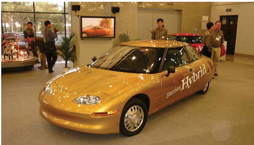
Kuva 2.71. Biokaasukäyttöisen kaasuturbiini/sähköhybridin GM:n ”EV1 Series Hybrid” prototyyppi Pekingin EVS-16-sähköajoneuvokongressissa vuonna 1999. Kyseinen auto soveltuu monien polttoaineiden käyttöön, mukaan lukien biokaasu ja bensiini. [Peter Van den Bossche, Wikimedia Commons, Creative Commons Attribution ShareAlike 2.5 License]
