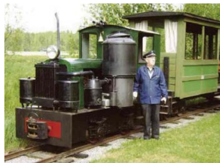
Kuva 2.68. Harvinaisempia puukaasujoneuvoja: a) Puukaasuttimella varustettu vuosimallin 1936 AJS-moottoripyörä Mobilian näyttelyssä. [2006] b) Carl Johan Bäckbacka ja hänen kunnostamansa vuonna 1942 valmistunut Volvon ottomoottorilla ja AKMO-puukaasuttimella varustettu teollisuusveturi. [Bengt Juselius 2007]
