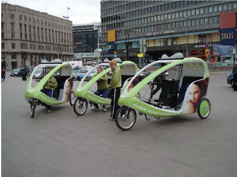
Kuva 2.88. Saksalaisvalmisteisia sähköavusteisia 250 watin sähkömoottorilla varustettuja Velotaxi-riksoja Helsingin rautatieasemalla toukokuussa 2007. Matkustajan istuimen alla olevat akut ladataan Helsingissä tuotetulla kivihiili- ja maakaasusähköllä, joten vain polkemalla tuotettu energia on bioenergiaa. Samanlaiset polkutaksit tulivat samaan aikaan käyttöön myös Tallinnassa, öljyliuskesähköllä ladattavina. [2007]
