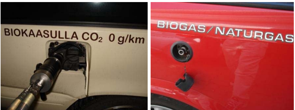
Kuva 6.10. Bifuel-autojen tunnusomaisin merkki on kaksi erilaista polttoaineen täyttöaukkoa: a) Tehdasvalmisteisissa autoissa molemmat ovat saman kannen alla. Tässä tankataan biokaasua vasemmalla olevan kaasutankin aukosta ja bensatankin korkki jää oikealle. b) Erillinen koriin porattu kaasuntankkausaukko konvertoidussa autossa. [2008]
