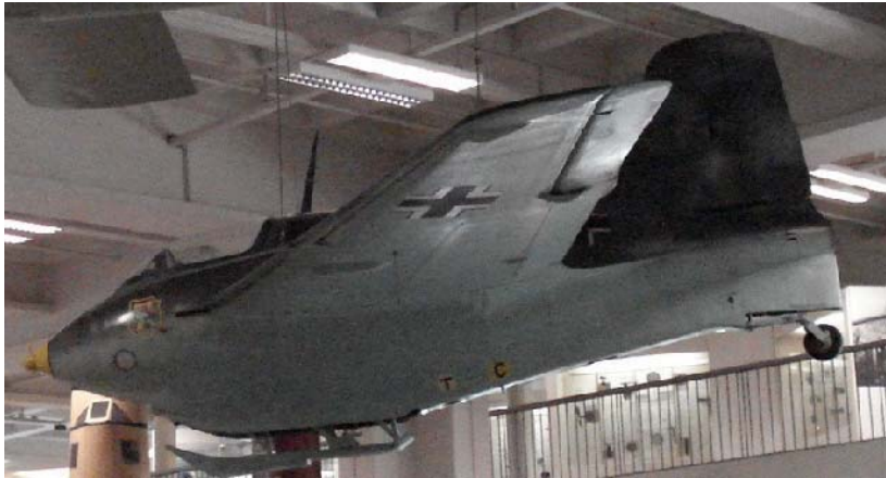
Kuva 2.82. Metanoli- ja hydratsiinikäyttöinen Me163B Deutches Museumissa Münchenissä. Me163 lensi ensi kerran vuonna 1941. Se oli maailman ensimmäinen sarjavalmistukseen ja palveluskäyttöön otettu rakettimoottorikäyttöinen lentokone vuonna 1944. Se saavutti 1000 km/h nopeuden. [2007]
