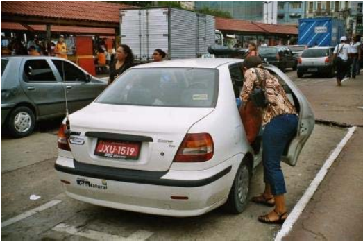
Kuva 6.12. Multifuel-takseja: a) Fiat Siena TetraFuel Manauksessa Brasiliassa. Se pystyy käyttämään biokaasua, maakaasua, 100 % etanolia ja bensiiniä. [2006] b) Volvo V70 FT 2.5 GAS Tukholmassa. Se pystyy käyttämään biokaasua, maakaasua, 85 % etanolia ja bensiiniä. [2009]
