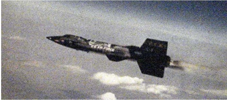
Kuva 2.114. Ammoniakkikäyttöisellä rakettimoottorilla varustetulla X-15:llä saavutettiin lentokoneiden korkeusennätys 108 km vuonna 1963 ja lentokoneiden nopeusennätys 6,7 Machia vuonna 1967. Kumpikin ennätys kesti pitkään, mutta ne eivät enää ole voimassa. [NASA]
