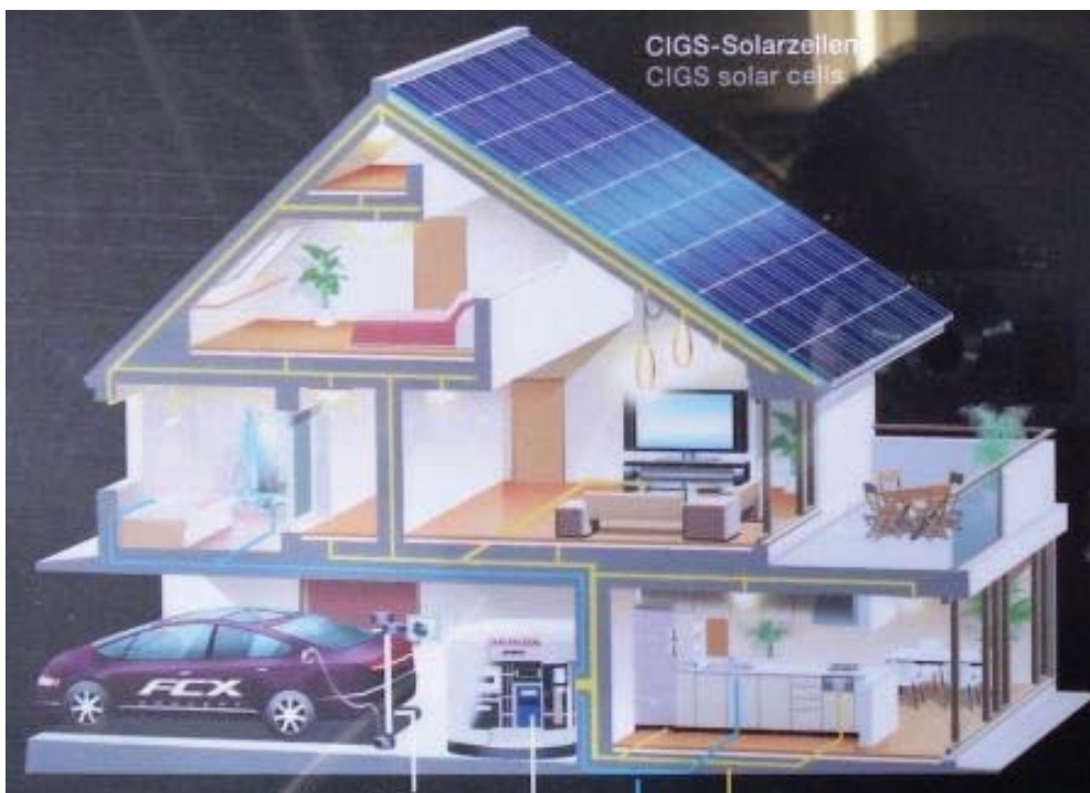
Kuva 2.60. Honda markkinoi Frankfurtin autonäyttelyssä FCX-polttockennoautonsa yhteydessä energiaomavaraista talokonseptia, jossa vety valmistetaan taloon integroiduilla aurinkopaneeleilla. [2007]
