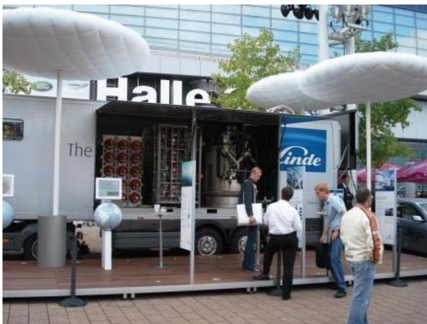
Kuva 2.49. Linden konttiin mahtuva vetytankkausasema Frankfurtin autonäyttelyssä. Kontti sisältää sekä paineistetun että nesteytetyn vedyn tankkausmahdollisuuden. [2007]
