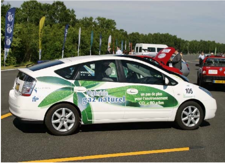
Kuva 6.18. Metaanikäyttöiseksi konvertoitu Toyota Prius -rinnakkaishybridiauto (Goldmann 2006). Sen ajonaikaiset CO 2 -päästöt ovat maakaasulla 80 g/km ja bensiinillä 104 g/km. Biokaasulla elinkaari-CO 2 ekv -päästöt ovat 6 g/km. [© Gröna bilister -kuva-arkisto 2006]
