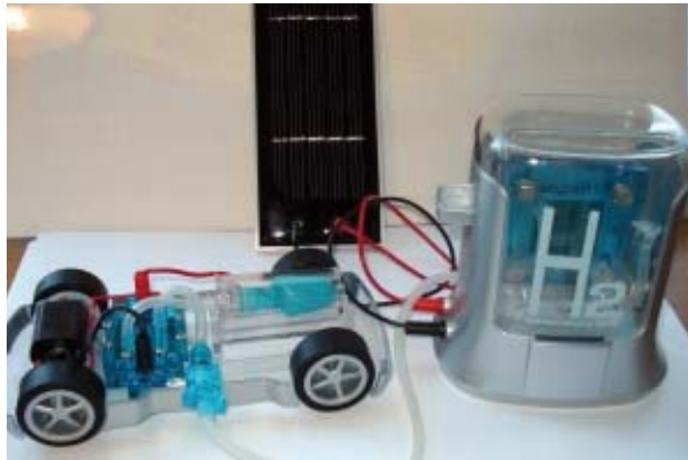
Kuva 5.24. 2 watin PEM-elektrolyseri ja malliautoon sijoitettu 0,24 watin PEM-polttokenno. Noin 100 euron hintaiseen Horizonin demonstraatioosarjaan kuuluu myös taustalla näkyvä 0,5 watin aurinkokenno aurinkovedyn tuottamiseksi. [2009]
