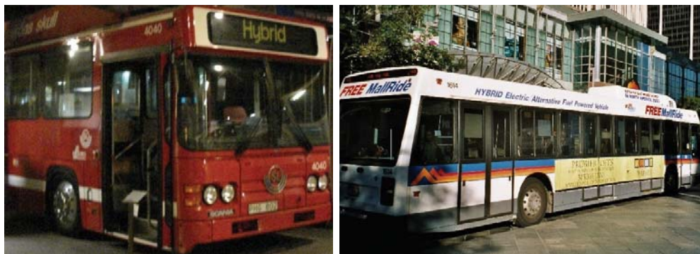
Kuva 2.98. Sähkö-otto-sarjahybridibusseja kaupunkiliikenteessä: a) Tukholmassa liikennöinyt Scanian bensiinikäyttöinen hybridibussi vuosimallia 1993 Tukholman liikennemuseossa. [2007] b) Denverin keskustassa vuodesta 2001 alkaen liikennöinyt TransTeq:in maakaasukäyttöinen (CNG) hybridibussi. [2004]
