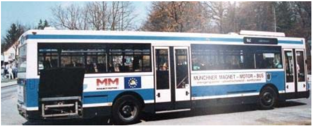
Kuva 2.32. Münchenin kaupunkiliikenteen vauhtipyöräbussi vuodelta 1988. Vauhtipyörä näkyy bussin perällä. Kuva Deutsches Museumissa Münchenissä. [2007]
