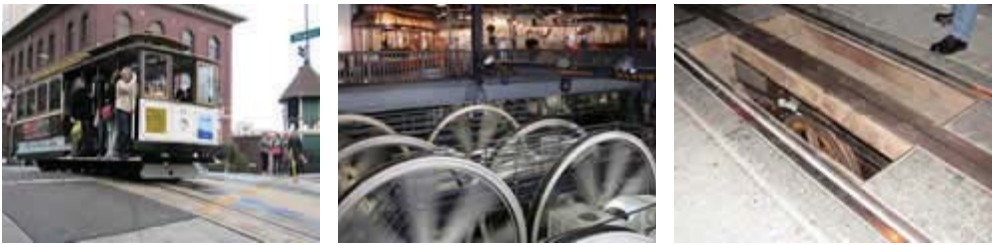
Kuva 2.43. San Franciscon kaapeliraitiovaunu (a), sen vetopyörästä (b) ja vetokaapeli raiteiden välissä (c). [© San Francisco Cable Car Museum]
