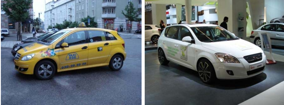
Kuva 6.11. Yleisimmät bifuel-tyypit: a) Metaani-bensiini-bifuel-auto MB B170 NGT biokaasukäyttöisenä taksina Tukholmassa. [2009] b) Nestekaasu-bensiini-biofuel-auto Kia Cee'd LPG Frankfurtin autonäyttelyssä. [2007]
