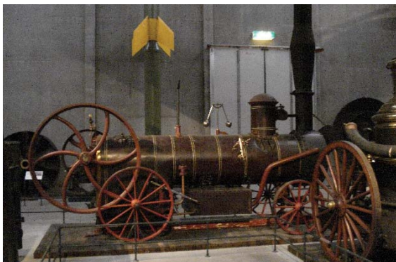
Kuva 2.38. Ruotsalainen Munktellin 6 kW:n puukäyttöinen höyrylokomobiili vuodelta 1861 tekniikan museossa Tukholmassa. [2006]
