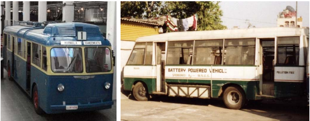
Kuva 2.86. Sähköbussien sähkö voidaan saada kaapelin kautta tai ajoneuvossa olevista akuista: a) Suomen ensimmäinen, pääasiassa vesivoimakäyttöinen, johdinbussi, joka aloitti liikennöinnin Tampereella vuonna 1948, näytteillä Tampereen Vapriikki-museossa. b) Delhin kaupunkiliikenteen akuilla varustettu sähköbussi. Akut ovat kuvassa näkyvissä matkatavaratilassa. Niitä ladataan sekä sekaenergialla että aurinkosähköllä. [2007, 1997]
