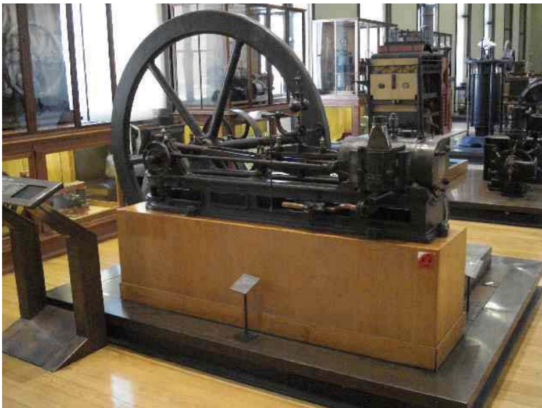
Kuva 2.51. Lenoirin vuonna 1861 valmistama kaupunkikaasukäyttöinen moottori Musée des Arts et Métiers:issä Pariisissa. Se oli ensimmäinen sarjavalmisteen ja kaupallisesti menestynyt polttomoottori. Lenoir valmisti myös mm. etanolilla ja tärpätillä käytettäviä moottoreita. [2007]
