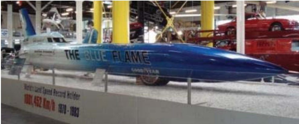
Kuva 3.26. Nesteytettyä metaania käyttänyt rakettimoottoriauto “Blue Flame” oli ensimmäinen auto, joka ylitti 1000 km/h nopeuden, vuonna 1970. Se on nykyään esillä Sinsheimin auto- ja tekniikkamuseossa Saksassa. [2007]
