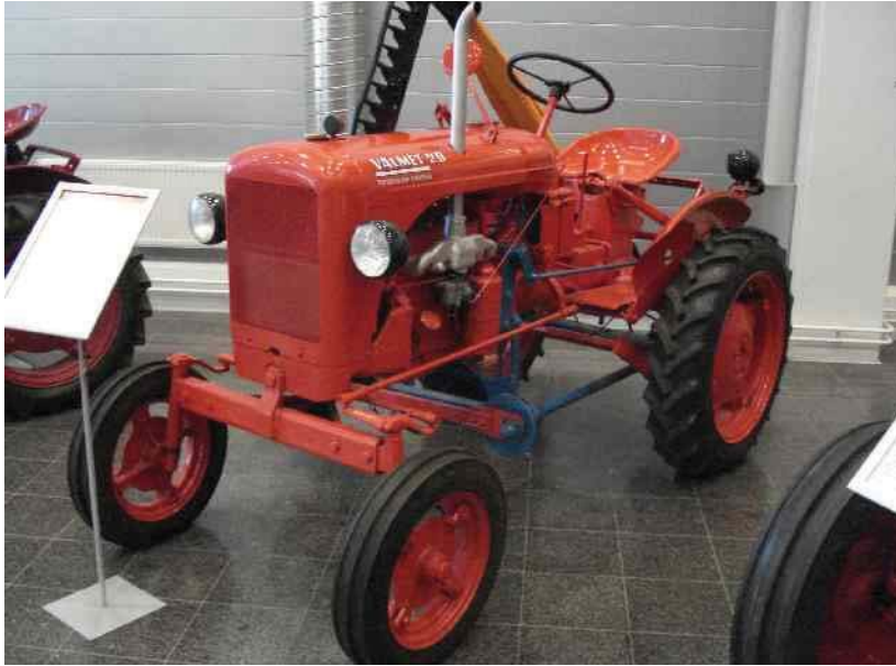
Kuva 2.80. Valmet 20 -traktori, jota valmistettiin vuosina 1955-1963, Valtran tehtaan näyttelyssä Suolahdessa. Se soveltui bensiinin, petrolin ja etanolin käyttöön. [2008]
