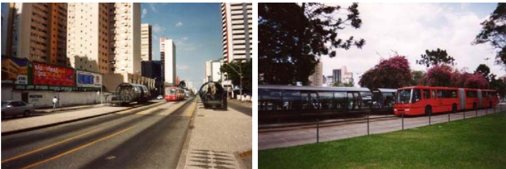
Kuva 9.6. Curitiba Brasiliassa busseille on varattu omat katukiveyksiin erotetut kaistat, joihin muilla ajoneuvoilla ei ole pääsyä. Tässä ns. pintametrojärjestelmässä liikennöivät erikoispitkät Volvon etanolikäyttöiset korkealattiabussit, jotka ottavat matkustajia metroaseman tapaisilta laitureilta. [2000]
