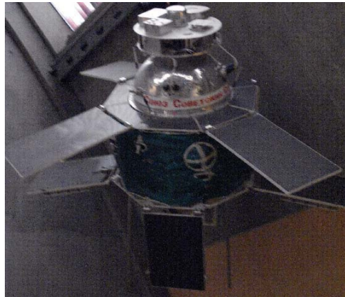
Kuva 2.6. Kopio neuvostoliittolaisesta tutkimussatelliitista vuodelta 1969 Tukholman teknikan museossa. Se käytti Maan gravitaatiota rataliikkeessä, Kuun gravitaatiota ohjauksessa ja aurinkopaneelien tuottamaa sähköä elektronikassaan. Satelliitteja on lähetetty yli 2000, joista 860 oli toiminnassa vuonna 2007. [2006]
