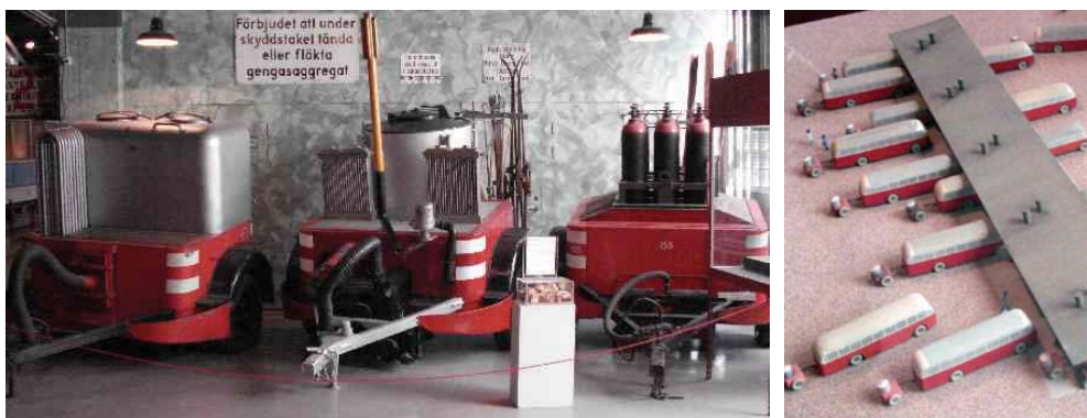
Kuva 2.66. Tukholmassa kaasukäyttöiset bussit vetivät 1940-luvulla perävaunua, joka sisälsi (vasemmalta oikealle) puuhiilikaasuttimen, pilkekaasuttimen tai jätevedenpuhdistamossa valmistettua paineistettua biokaasua (a). Kaasun loputtua vaihdettiin perävaunua varikolla (b). Perävaunut ovat näytteillä Tukholman raitiovaunumuseossa. [2007]
