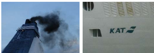
Kuva 7.12. Mustaa savua katalysaattorilla varustetun M/S Silja Symphony -laivan yhdestä sen neljästä 8145 kW:n dieselmoottorista Tukholman satamasta lähtiessä. Käytössä on ns. matalarikkinen, alle 0,5 %, dieselöljy. [2006]
