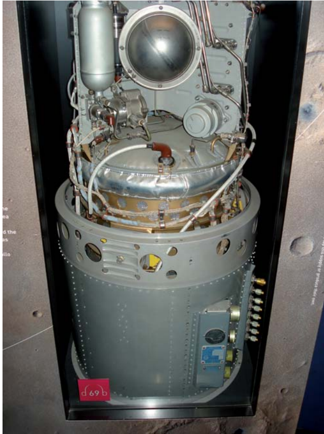
Kuva 2.59. Apollo-avaruusaluksissa 1960-1970-luvuilla käytetty polttokenno Lontoon tiedemuseossa [2007].
