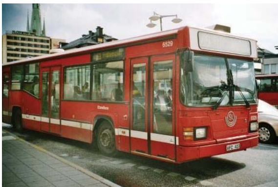
Kuva 3.11. Scanian etanolikäyttöinen (E93) dieselbussi Tukholmassa. Etanolin alhainen setaaniluku on korvattu setaaninkorottajalisäaineella ja puristussuhde on 22, joten hyötysuhde on dieselöljykäyttöisiä busseja parempi. [2006]
