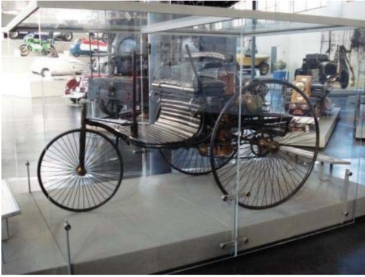
Kuva 2.52. Benzin ja maailman ensimmäinen ottomoottoriauto (1885) Münchenin liikenteenteeniikan museossa. Voimanlähteenä on Benzin suunnittelema bensiinillä ja kaupunkikaasulla toimiva 0,8 hv:n 1-sylinterinen 0,96-litrainen puristusasteen 2,68:1 ottomoottori, joka kuljetti autoa 16 km/h nopeudella. [2007]
