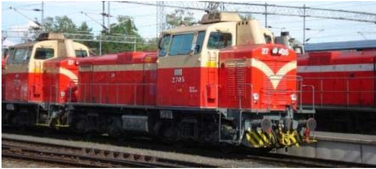
Kuva 6.19. Dieselveureina tunnetuksi tulleet veturit ovat dieselsarjahybridejä. [2009]
