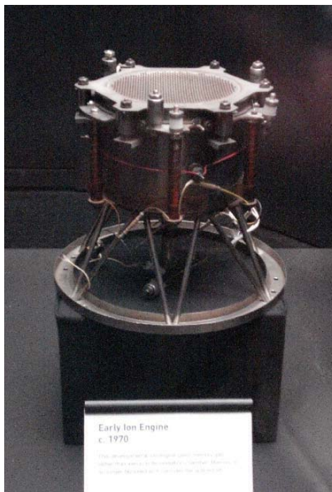
Kuva 2.30. a) Ionimoottori vuodelta 1970 Lontoon tiedemuseossa. [2007] b) Aurinkopaneelikäyttöinen Hall-ionimoottori ruotsalaisen vuonna 2003 lähetetyn Smart 1 -kuuluotaimen voimanlähteenä, piirros. [© ESA]
