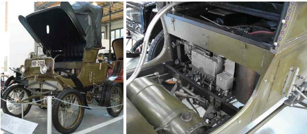
Kuva 2.41. Amerikkalainen Mobile-höyryauto ja sen vesisäiliö vuodelta 1900 Münchenin liikenne-tekniikan museossa. Mobilet valmistettiin Stanley-patenteilla. [2007]
