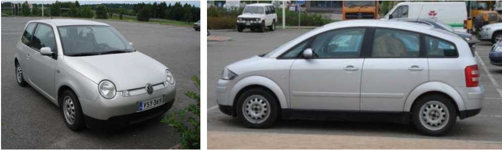
Kuva 7.16. 3 l/100 km kuluttavia 4-paikkaisia autoja: a) Käytettynä Suomeen tuotu VW Lupo 3L TDI Muuramessa. [2008] b) Eestiläinen Audi A2 1.2 TDI 3L Varkaudessa. [2009]
