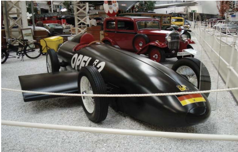
Kuva 2.27. Kopio Opelin mustaruutikäyttöisestä rakettiautosta Opel RAK 2 vuodelta 1928 Speyerin teknologiamuseossa Saksassa. Se saavutti 230 km/h nopeuden. Se on varustettu siivillä (spoilereilla), mutta päinvastaisesta syystä kuin lentokoneilla: niiden tarkoitus on estää lentoon lähteminen. [2007]
