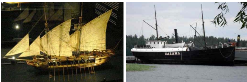
Kuva 6.15. UE-hybridilaivoja: a) Malli vuonna 1764 rakennetusta Ruotsin saaristolaivaston tuuli- ja lihasvoimaa hyödyntäneestä Pohjanmaa-luokan aluksesta Suomen merimuseossa Kotkassa. [2009] b) Purje-puu-höyrylaiva Salama Savonlinnassa. [2008]
