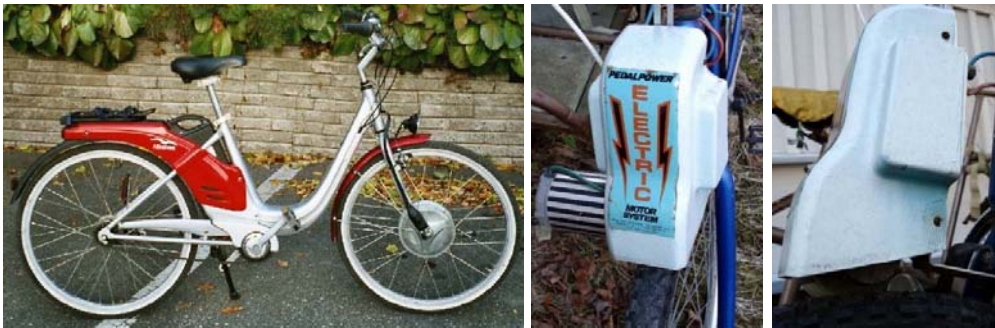
Kuva 6.16. a) Tuulivoima-biovoima-hybridiajoneuvoja, joissa tuulisähkö saadaan lataamalla akut tuulisähkösopimuksen tekevän kotitalouden pistorasiasta: sähköavusteinen Piaggio-polkupyörä (a) ja rakennussarjasta koottu sähköpolkupyörä (b-c). [2005]
