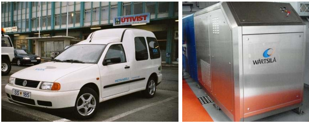
Kuva 7.3. a) Reykjavikin kaatopaikkakaasua käyttävä VW Caddy. [2003] b) Vaasan kaatopaikkakaasusta sähköä ja lämpöä tuottava Wärtsilän metaanipolttokenno. [2008]
