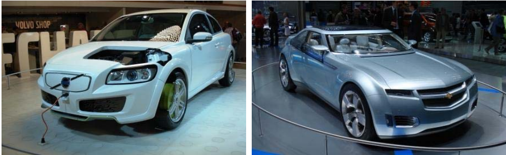
Kuva 6.17. Plug-in-hybridien prototyyppiä Frankfurtin autonäyttelyssä: a) Volvo C30 ReCharge Concept -rinnakkaishybridi pystyy käyttämään tuulisähköä ja etanolia. b) Sarjahybridi Chevrolet Voltin vetypolttokeino-versio. Autosta on olemassa myös bensiinimoottoriversio, joka on tulossa myyntiin vuonna 2011. [2007]
