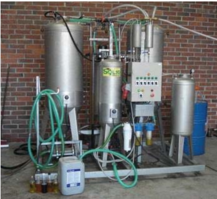
Kuva 5.9. Kotimainen Presecon SOL-10-biodiesellaitteisto Haapajärven ammattiopistolla opetuskäytössä. [2007]
