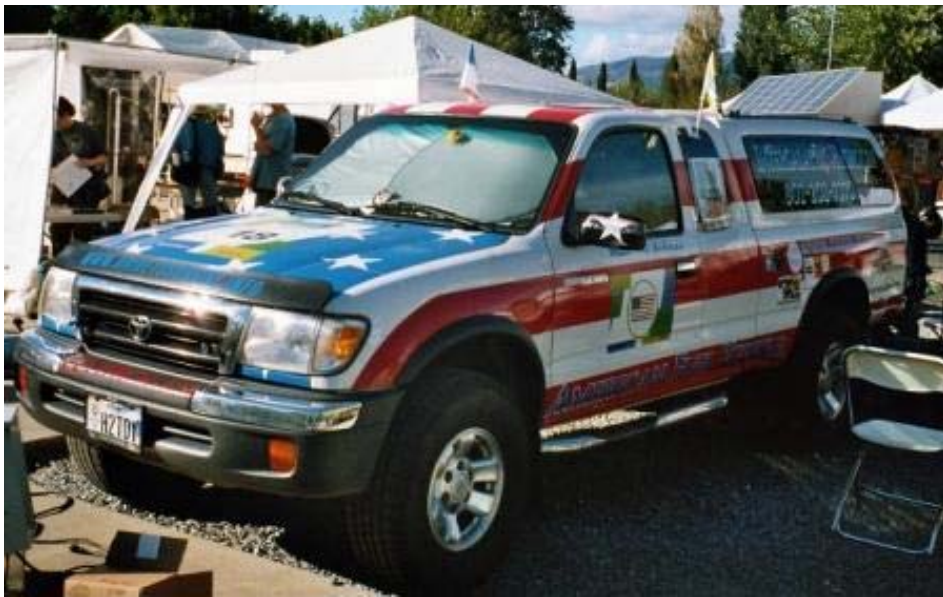
Kuva 6.13. Biokaasun, maakaasun, vedyn, etanolin, metanolin ja bensiinin käyttöön pystyvä jälkikonvertoitu Toyota-maastoauto uusiutuvan energian messuilla Hoplandissa Kaliforniassa. [2004]
