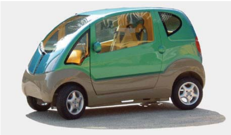
Kuva 2.103. Moderni paineilmakäyttöinen MDI:n MiniCAT-auto, jossa on 25 hv paineilma-moottori ja 150 km tankkausväli. (MDI 2007).
