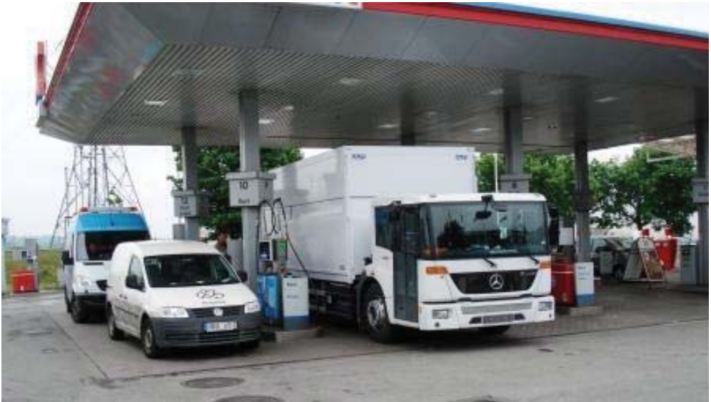
Kuva 2.132. Kolme erityyppistä CBG-autoa biokaasutankkaamassa OKQ8-aseamalla Tukholmassa. Raskas kuorma-auto MB Eonic NGT (monofuel), pakettiauto MB Sprinter NGT (bifuel) ja henkilöauto VW Caddy Ecofuel (bifuel). [2009]
