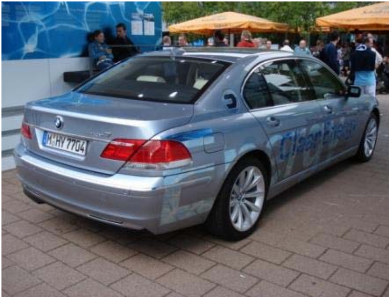
Kuva 7.8. Ottomoottorilla varustettu vety-bensiini-bifuel-auto BMW Hydrogen 7 Frankfurtin autonäyttelyssä. Harmittoman vesihöyryn lisäksi vedyn polton päästöinä saadaan ilman typen ja hapen yhdistymistuotteita eli NO x :eja ja N 2 O:ta. [2007]
