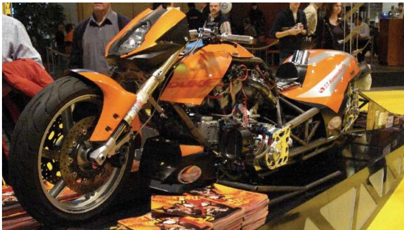
Kuva 3.20. Jaska Salakarin 1500 hv:n kiihdytysmoottoripyörä, jonka polttoaineesta 85–95 % on nitrometaania ja loput metanolia. [2006]
