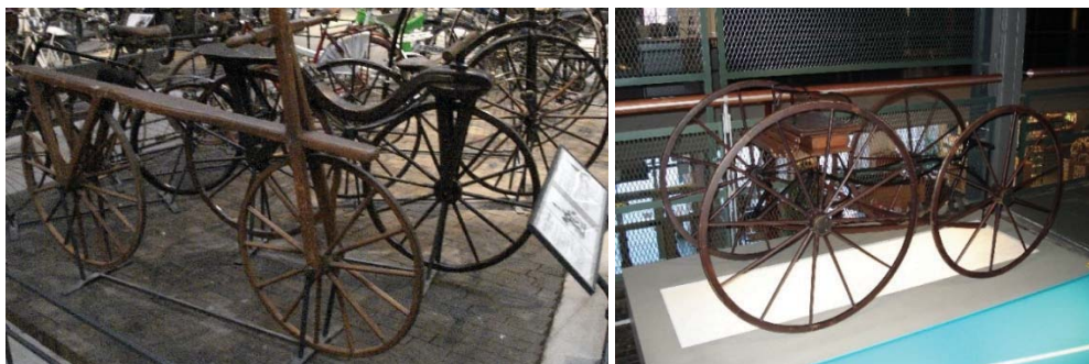
Kuva 2.4. a) Historiallisia 2-pyöräisiä Tukholman tekniikan museossa. Ensimmäisissä de Sivracin juoksupyörissä 1700-luvulta ei ollut polkimia eikä etupyörän ohjausta (edessä). Ensimmäiset etupyörän ohjauksella varustetut juoksupyörät tehtiin 1810-luvulla (toinen edestä) ja ensimmäiset polkimilla varustetut 2-pyöräiset polkupyörät valmistettiin 1850-luvulla (takana). [2006] b) Nelipyöräinen polkuvaunu 1840-luvulta Tampereen Vapriikki-museon Velomania-näyttelyssä. [2007]
