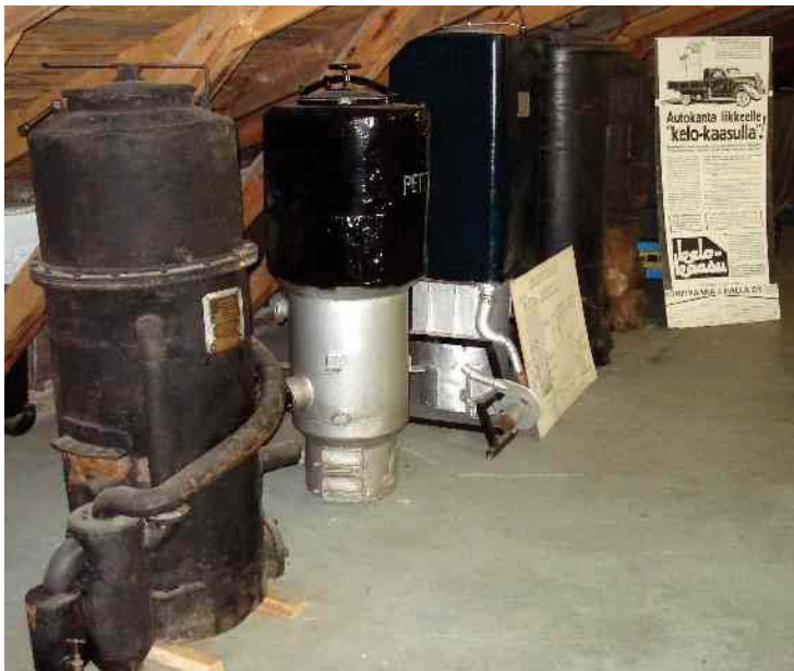
Kuva 5.15. Viisi kaupallista puukaasugeneraattoria Vaasan auto- ja moottorimuseossa: vasemmalta suomalainen AKMO-pilkekaasutin, suomalainen Petsmo-pilkekaasutin, ruotsalainen Svedlund-puhiilikaasutin, saksalainen Imbert-pilkekaasutin ja suomalainen Kelo-puhiilikaasutin. [2007]
