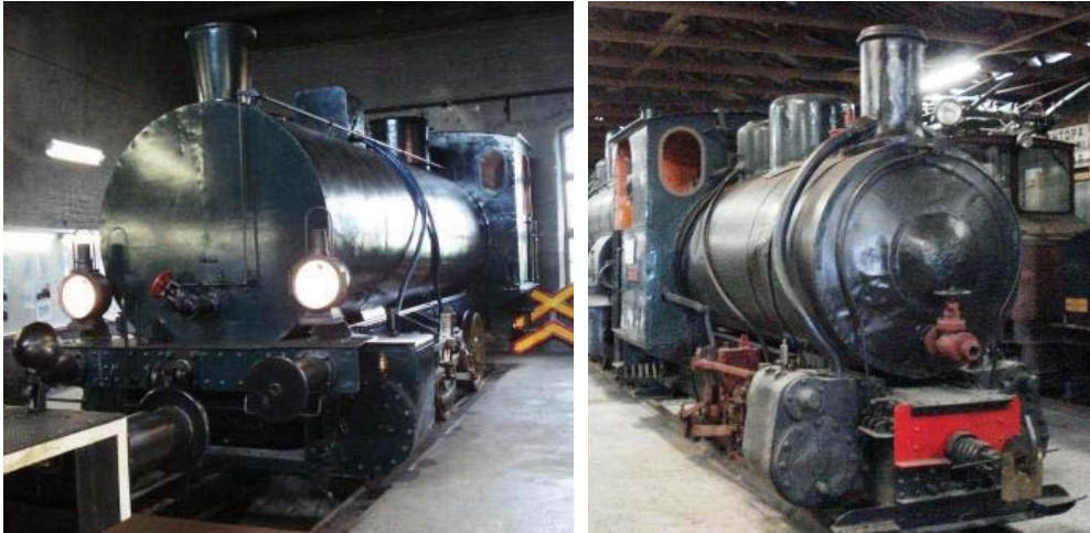
Kuva 2.105. Suomessa käytössä olleita painehöyryvetureita: a) Hanomag-höyrysäiliöveturi vuosimallia 1928 Toijalan veturimuseossa. [2007] b) Orenstein & Koppelin höyrysäiliöveturi ÅSR 3 vuosimallia 1929 Jokioisten museorautatien kokoelmassa. [2007]
