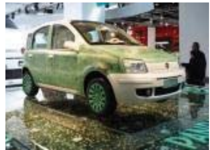
Kuva 3.29. Hytaanikäyttöinen Panda Aria Frankfurtin autonäyttelyssä. Se hyväksyy korkeintaan 30 e-% vetyä. [2007]
