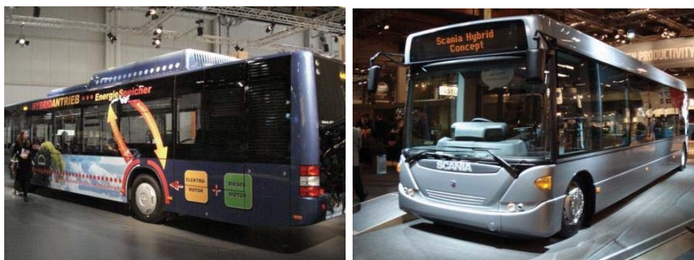
Kuva 2.99. Dieselhybridibusseja esittelyssä kansainvälisessä joukkoliikennekonferenssissa Helsingissä: a) MANin kaupallinen dieselsarjahybridit. Biodieseliä tai synteettistä biodieseliä käyttäen tällä päästään erittäin alhaisiin päästötasoihin. b) Scanian etanolidieselhybridin prototyyppi. [2007]
