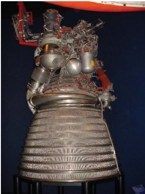
Kuva 2.50. Noin 10.000 MW tehoisia LH/LO 2 -käyttöisiä rakettimoottoreita: a) NASAn Apollo-lentojen Saturn V -kantoraketin J2-moottori vuodelta 1967 Lontoon tiedemuseossa. b) ESan Ariane 5 -kantoraketin Vulcan-moottori vuodelta 1980 Musée des Arts et Métiers:issä Pariisissa. [2007]
