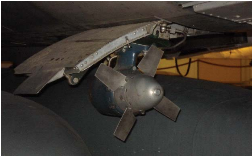
Kuva 2.24. Varavoimanlähteenä Suomen ilmavoimien käytössä olleessa ruotsalaisessa Draken-suihkuhävittäjässä toimiva rungosta ulos laskettava tuuliturbiini Keski-Suomen ilmailumuseossa Tikkakoskella. [2006]
