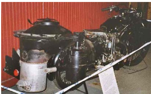
Kuva 2.68. Harvinaisempia puukaasujoneuvoja: a) Puukaasuttimella varustettu vuosimallin 1936 AJS-moottoripyörä Mobilian näyttelyssä. [2006] b) Carl Johan Bäckbacka ja hänen kunnostamansa vuonna 1942 valmistunut Volvon ottomoottorilla ja AKMO-puukaasuttimella varustettu teollisuusveturi. [Bengt Juselius 2007]
