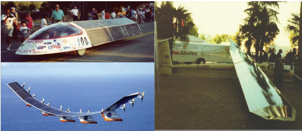
Kuva 2.135. a) Aurinkosähköauto Palo Altossa Kaliforniassa. [1991] b) NASAn miehittämätön 180 m 2 aurinkopaneelikäyttöinen 40 kW Helios-lentokone [© NASA] c) Aurinkovoima-purjelentokone näytteillä Eurosun96-konferenssissa Freiburgissa Saksassa. Siiven yläpinta on päällystetty aurinkopaneeleilla. [1996]
