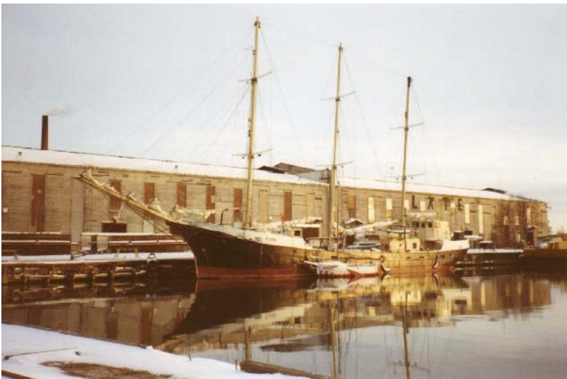
Kuva 2.15. Reilun kaupan tuotteita kuljettava Eestaas-yhtiön 247 brt:n purjelaiva S/V Estelle peruskorjattavana Turussa. Estelle on hybridiajoneuvo, jonka nimellinen tuulivoimateho on 645 kW m ja varavoimanlähteenä olevan 2-tahtisen dieselmoottorin nimellisteho on 180 kW m . [1995]
