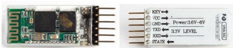
Kuva 4. Velleman HC-05 Bluetooth-moduuli ja pinnijärjestys. [25]
